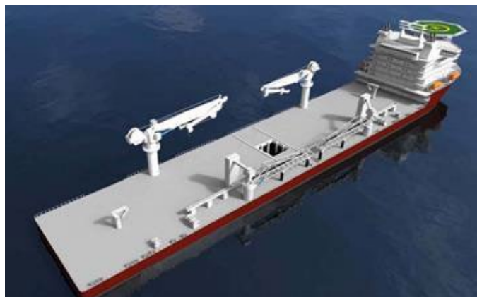
Figur 18 - Kran utrustningen ombord på Nautilus New Era. Kranene er levert av det norske selskapet McGregor kranene er levert av det norske selskapet McGregor. (DNV, 2021)
