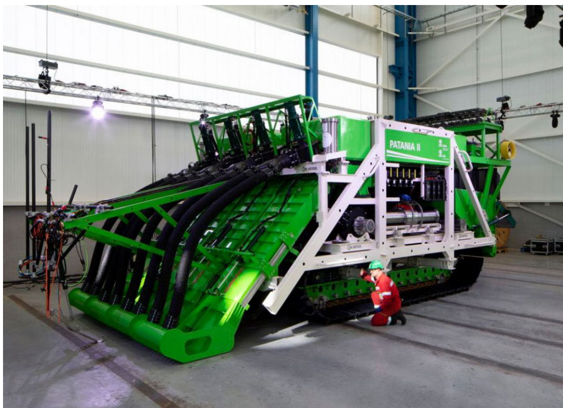
Figur 11 - Havbunnskjøretøyet Patania II, utviklet av GSR. I Forkant av kjøretøyet (til venstre i bildet) er det montert oppsugingslanger som høster inn mangannodulene. (Bruyne, et al., 2022)
