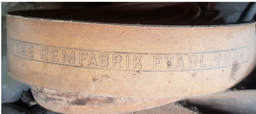
Fig.7 Balatareim fra: A/S Den norske remfabrik etablert 1894 Bildet tatt av Jørn Ulven
