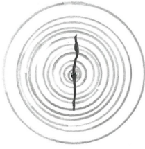
Fig. 24 Margsprekk i stokk. Tegning Ken Lorentzen
