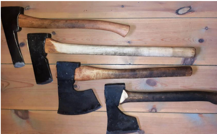
41. Øksene og bilene som er brukt ved prøvetømringa. Øvst Banco køyreøks 1 3/4". Dei tre andre er nysmidde av Pål Lien, fyrst hoggarøks 2 1/2" Telgjebile 6 1/2" og laftebile 5"
