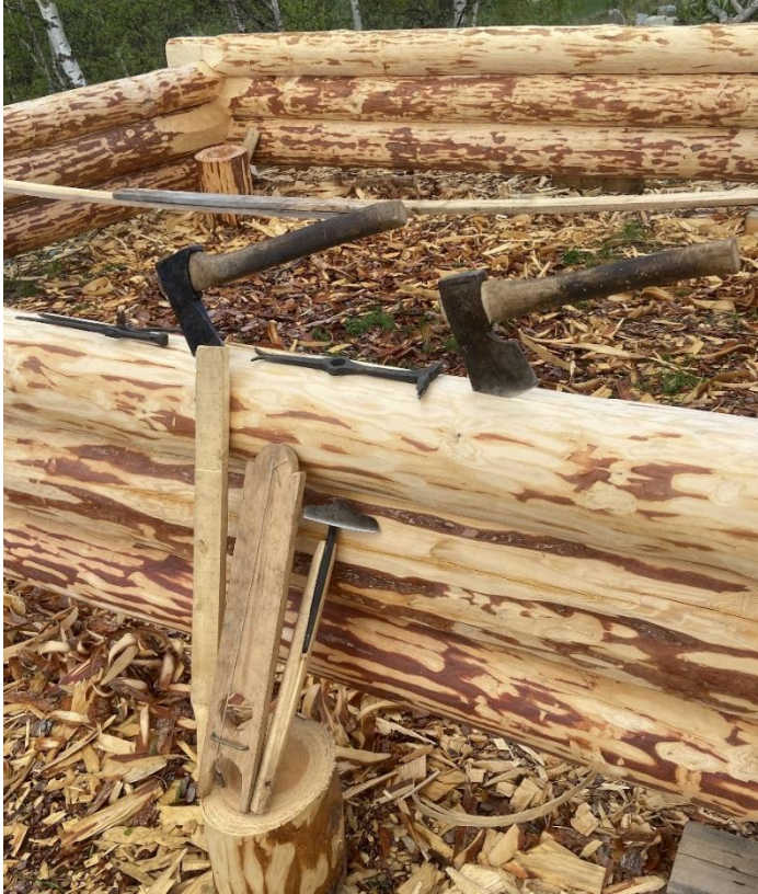
14. Verktøyet eg nytta i arbeidet. Kniven manglar. På laftestokken frå venstre, grov passar, hoggarøks, smidd mé med maur, lita bile, på stabben, frå venstre, alenstav, loddefjøl og pjål. (Foto: Aabol)
