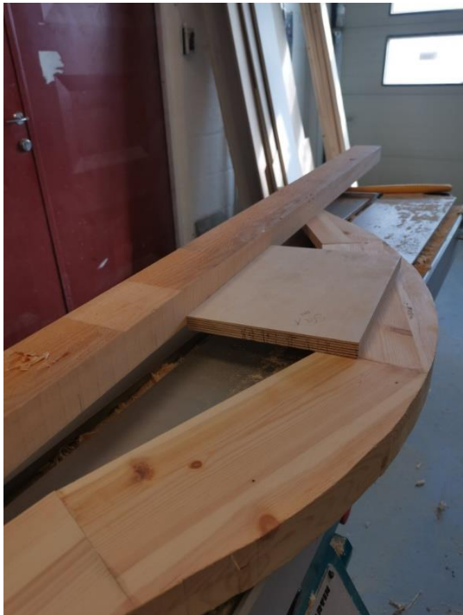
Bilde 50 Metoden fungerer utmerket hvis materialet er buet eller skal ha en buet form for gunstigere utforming av profilen. Foto Helge Kleemann
