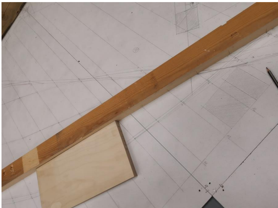
Bilde 46 Lekten danner materialenes ytterkant. Profilen blir avmerket på klossen. Foto Helge Kleemann
