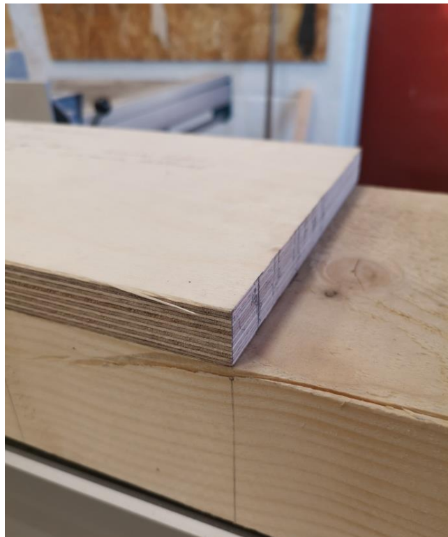
Bilde 48 Klossen legges i kant med høydelinjen og profillinjens avstand til kanten kan merkes av. Foto Helge Kleemann
