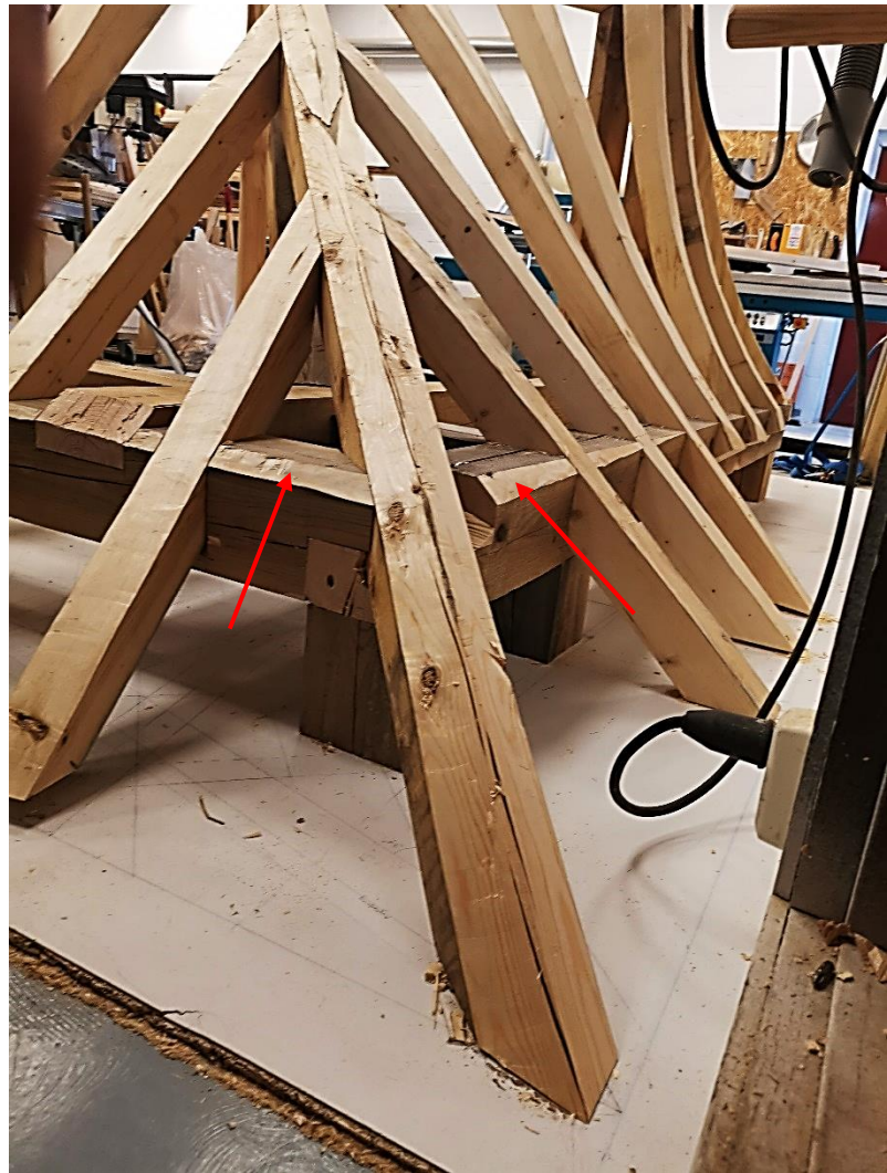
Bilde 63 Yttersvillen blir faset av mot gradsperran. Foto Helge Kleemann
