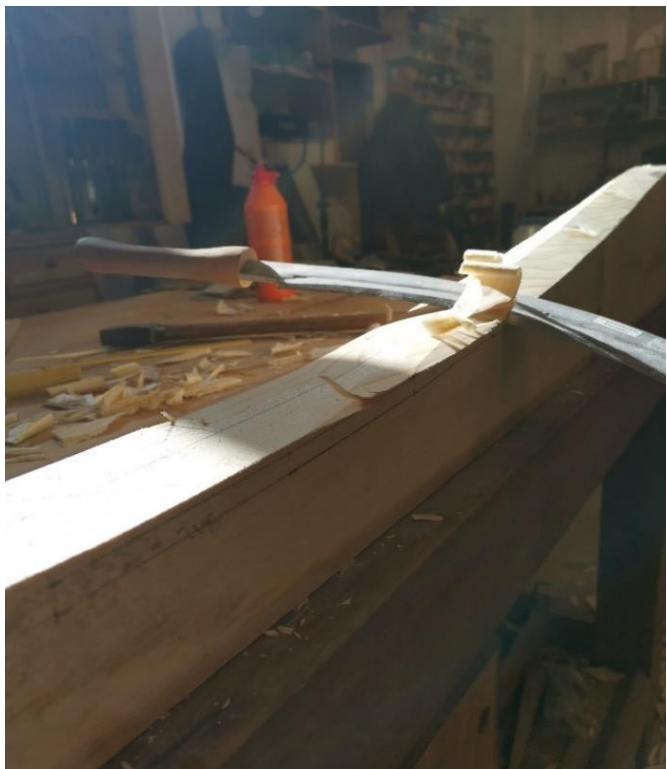
Bilde 51 Utarbeiding av sperrens avgrating. Foto Helge Kleemann
