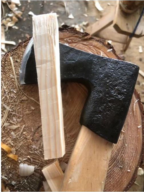
Figur 69 Nagleskjæring med øks
