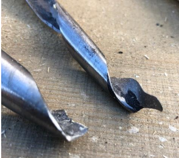
Figur 86 Det går hardt utover navarane
