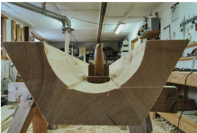
Figur 11. Høvling av innvendig bue ved svingstykke med tilpasset høvel.
