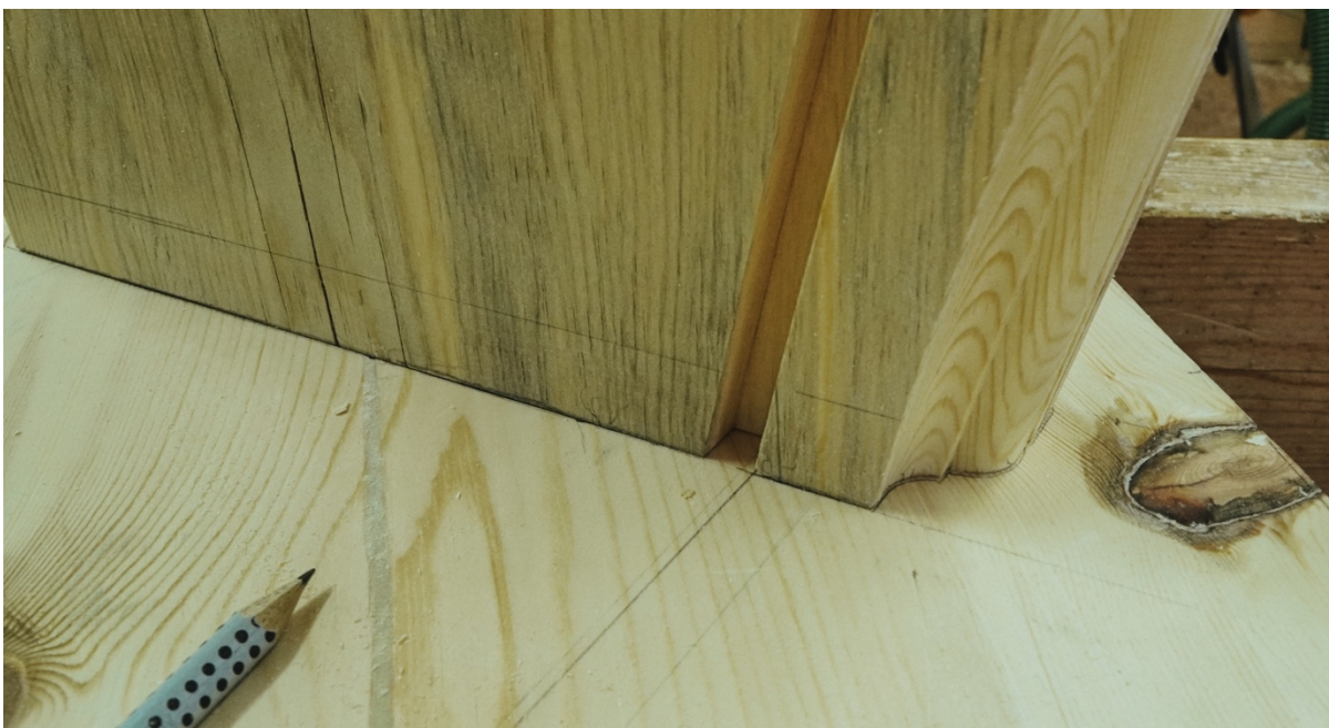
Figur 12. Overføring av trinnese samt profil i riktig vinkel til vangen.
