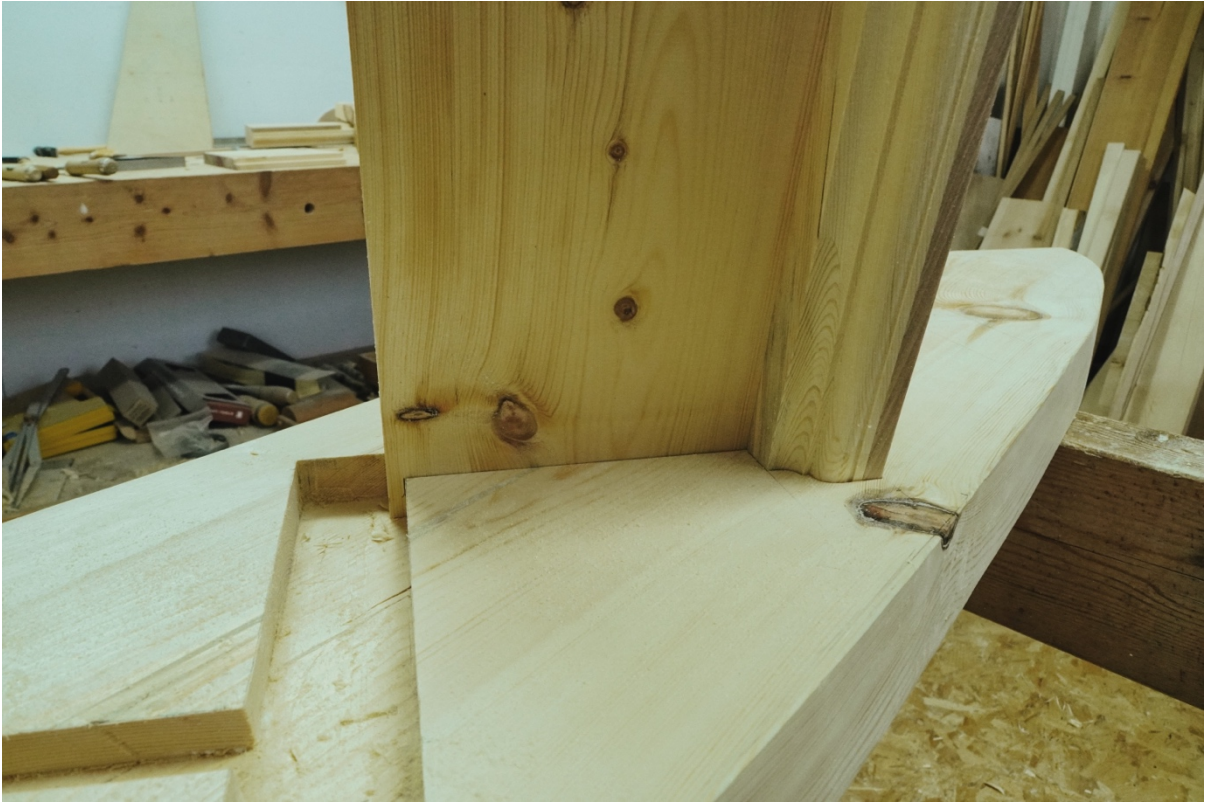
Figur 13. Spor i vangen med montert stuss og inntrinn.
