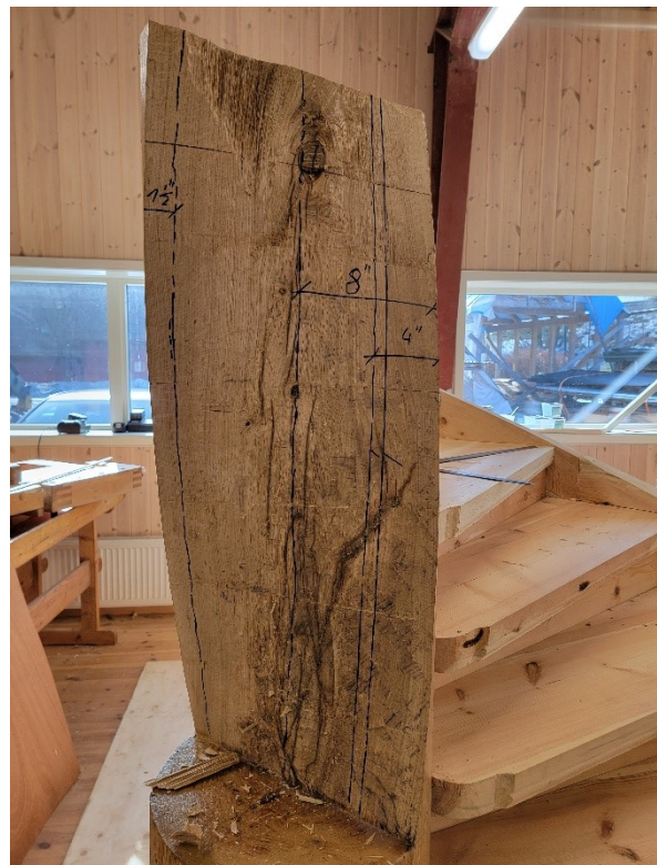
Bilde 61: Det ble streket opp hjelpelinjer fra sentrale punkt ved profilen. Det var tydelig at tommer var brukt under oppmerkingen, fordi alle viktige mål gikk opp i hele eller halve tommer.
