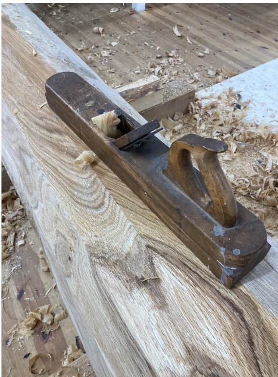
Bilde 46: Til slutt formes spindelen rund med rubank (en lang høvel)
