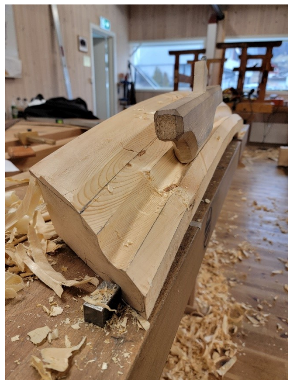
Bilde 77: Høvlene som er laget til denne jobben er utformet slik at man kan høvle både konvekse og konkave profiler med samme høvel.
