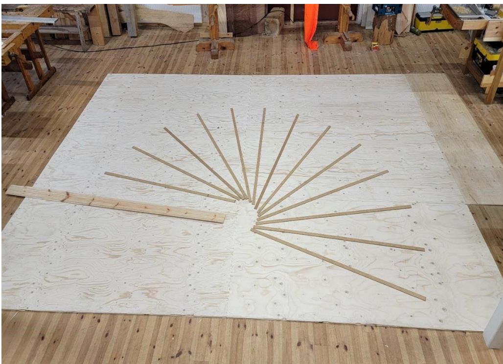
Bilde 22: Bildet viser lektemetoden som forfatterne mener har vært benyttet. Lekter som representerer trinnene, legges ut på grunnrisset og med øyemål bestemmes plassering og dybden til inntrinnene. Metoden er rask og effektiv og har spart snekkeren for en del arbeid og matematiske utregninger i opptegningen av original trappen.
