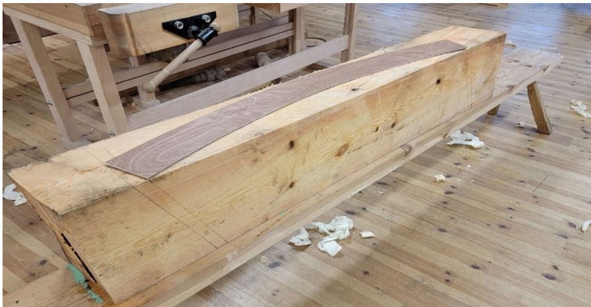
Bilde 29: Vangens yttermål ble overført til emne med hjelp av grisen.
