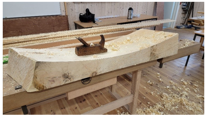
Bilde 31: Høvel med konvex såle ble brukt til finpussing.
