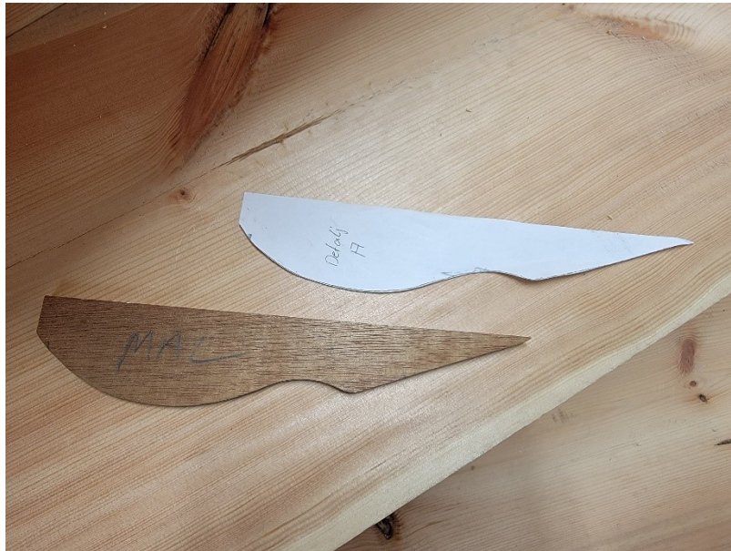
Bilde 23: Malene som ble brukt til å overføre distansekurven. Malen tar utgangspunkt i kurven til trinn 4 på originaltrappa.
