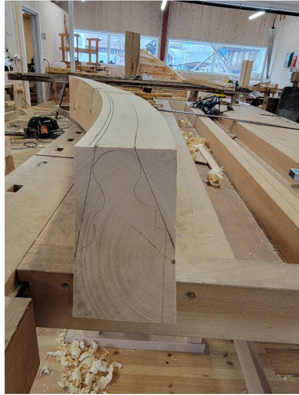
Bilde 75: Så overføres profilen til endeveden og man tegner hjelpelinjer for å skape referanseflater.
