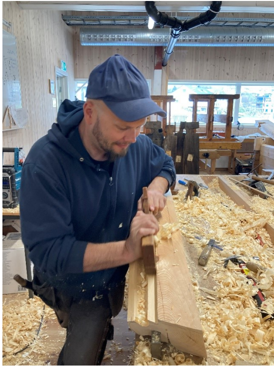
Bilde 80: Det var en delvis tung og tidkrevende prosess å høvle håndrekken.
