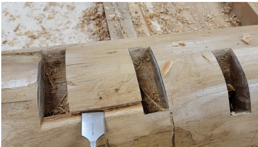
Bilde 50: Stusstrinnene er bare så vidt felt inn i spindelen
