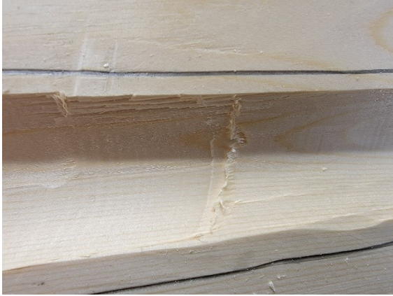
Bilde 78 og 79: Det oppstår liknende verktøyspor som på original håndrekken, under høvelprosessen.
