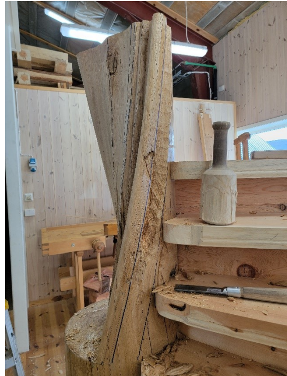
Bilde 63: Skulpjern og profilhøvler ble brukt under arbeidet. Det viste seg at samme høvler som ble brukt under framstilling av håndrekken kunne brukes ved spindelen.
