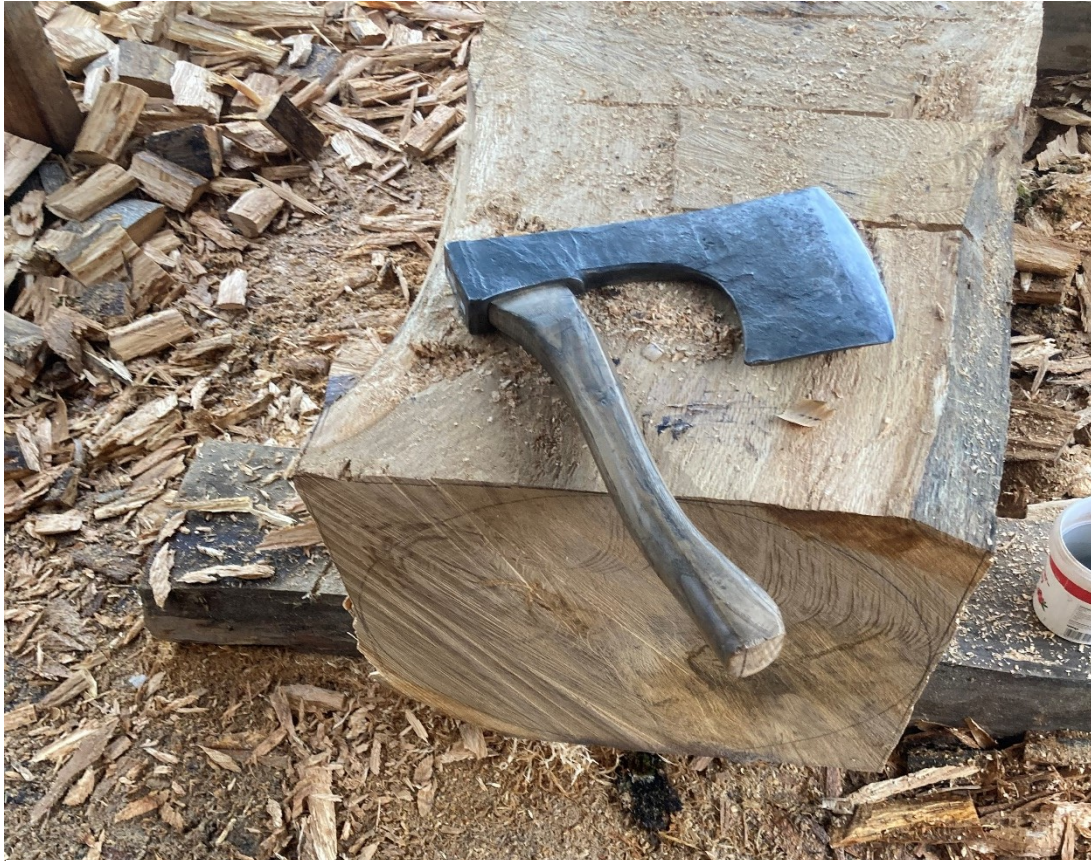
Bilde 42: Det å få emnet kvadratisk var den tyngste jobben. På bildet ser vi ryerbilen som ble brukt under prosessen.
