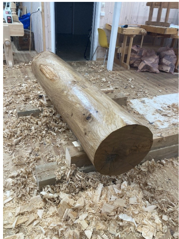
Bilde 47: Etter at spindelen var formet, ble den behandlet med flere strøk klarlakk. Dette skal forhindre at veden tørker for rask og sprekker.
