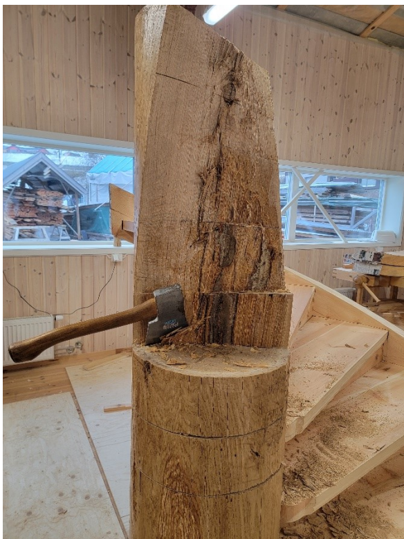
Bilde 60: Etter at det var skjært inn med to-mannssvans ble veden fjernet med snekkerøks.
