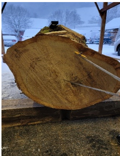
Bilde 40: Spindelens radius blir markert i endeveden.
