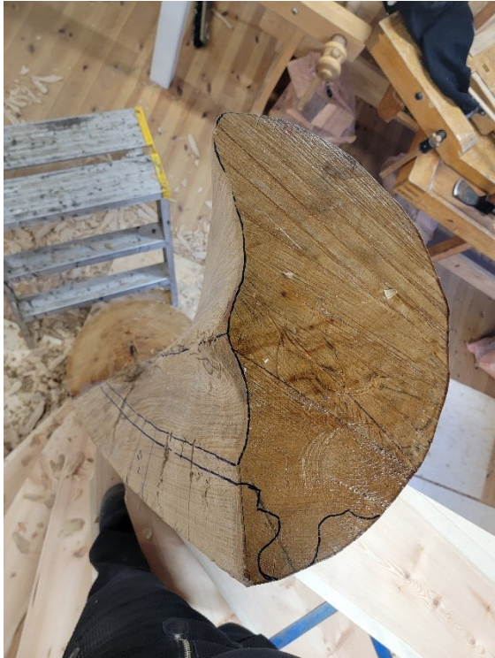
Bilde 62: Steg for steg ble spindelens profil utarbeidet.
