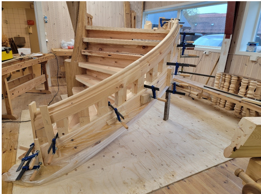
Bilde 89: Bordet ble bøyet rundt vangen med posen på. Det i tilfelle det måtte steames mer, noe som viste seg å ikke være nødvendig. Bordet ble holdt på plass med tvinger og kunne avkjøles over natten. Til slutt ble bordet skrudd fast.
