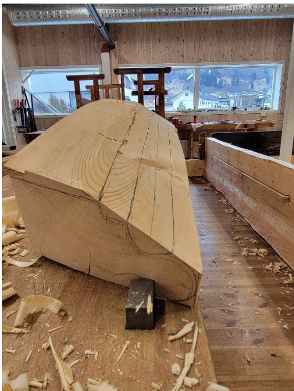
Bilde 76: Når flatene er høvlet streker man opp for plater og hulkiler.
