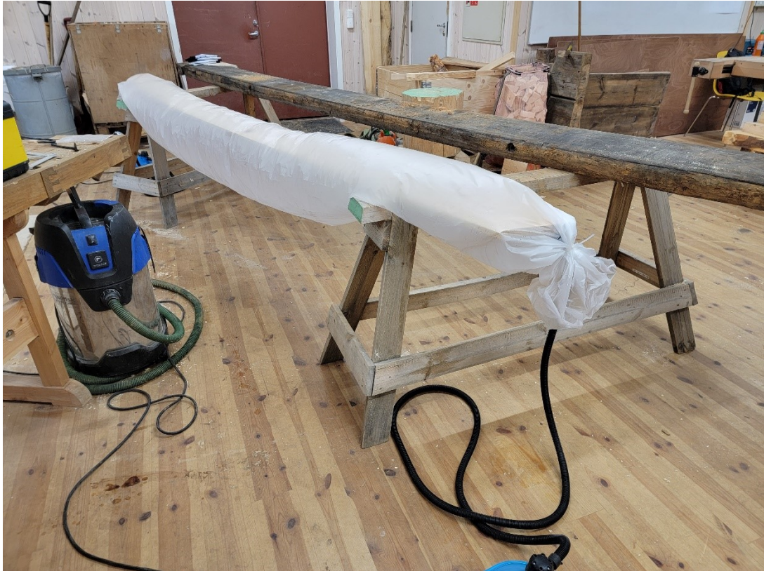
Bilde 88: For å slippe å lage en steamkasse, ble det brukt en steampose. En tapetfjerner på hver ende sørget for nok vanndamp.
