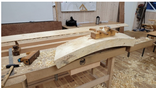
Bilde 32: På yttersiden ble det brukt høvel med rett såle.
