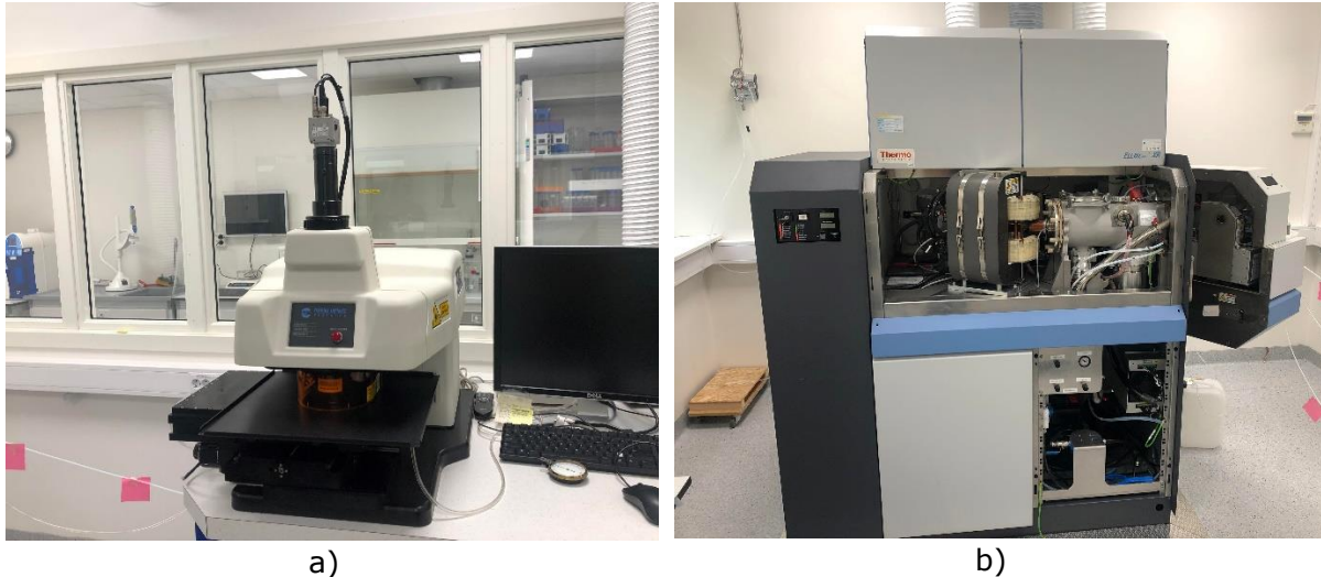
Figur 5.14: Instrument LA-ICP-MS. a) Lasersystem av type New Wave UP-193 Excimer til ablasjon av faste stoffer. b) Thermo Fischer Scientific ELEMENTXR ICP-MS .
