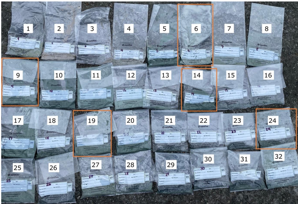
Figur 5.5: Oversikt over de 32 kaksprøvene som ble samlet inn ved boringen av testbrønn i Nardovegen 12-14. Nummeret på hver pose indikerer rekkefølgen de ble hentet inn i. Dvs. at prøve nr. 32 er fra dypest ned. Prøvene markert med oransje (6, 9, 14, 19 og 24) ble valgt ut til XRD-analyse. Disse prøvene vil heretter presenteres med prøve nr.: 78-82.
