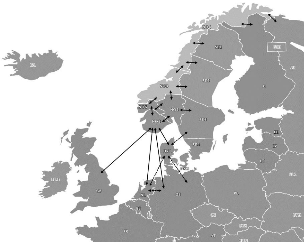
Figur 2: Viser hvordan de ulike norske prisområdene er koblet sammen med hverandre og med utenlandske prisområder. Stiplede linjer er satt inn mellom land som er tilknyttet hverandre og samtidig tilknyttet NO2. Kilde: Redigert selv basert på oversiktsbilde fra Nord Pool (2020(4)) og oversikt over kraftforbindelser Statnett (2022(1)).
