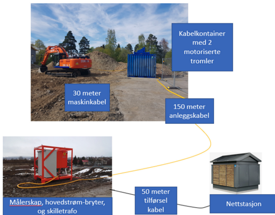
Figur 10: Prinsippskisse av en kablet elektrisk gravemaskin (21)
