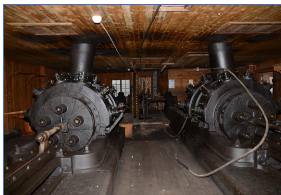
Interiør og tvillingblåsemaskin i Nedre Maskinhus. Foto: Rørosmuseets arkiv, 16.11.2011
