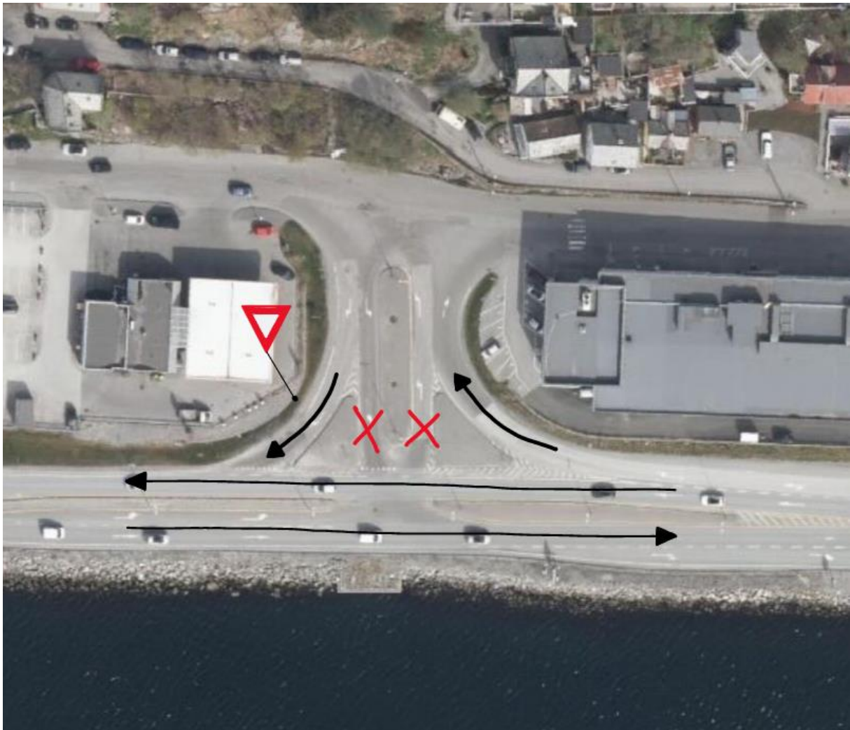
Figur 21. Skisseforslag for alternativ 1 ved Ysteneskrysset. Hentet fra kommunekart.no den 30.03.2022, og skissert i Microsoft OneNote.
