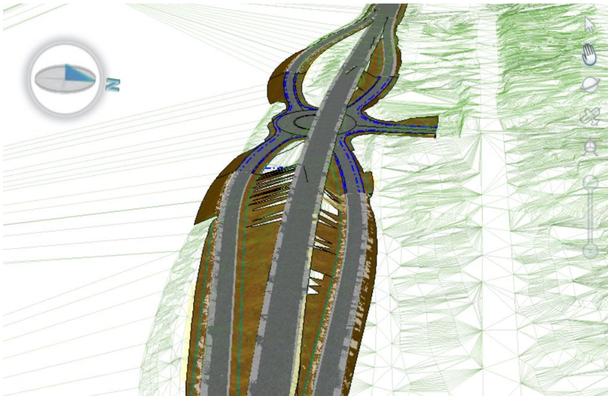
Figur 48. Forkastet fem-armet rundkjøring ved Ellingsøykrysset, modellert i Novapoint
