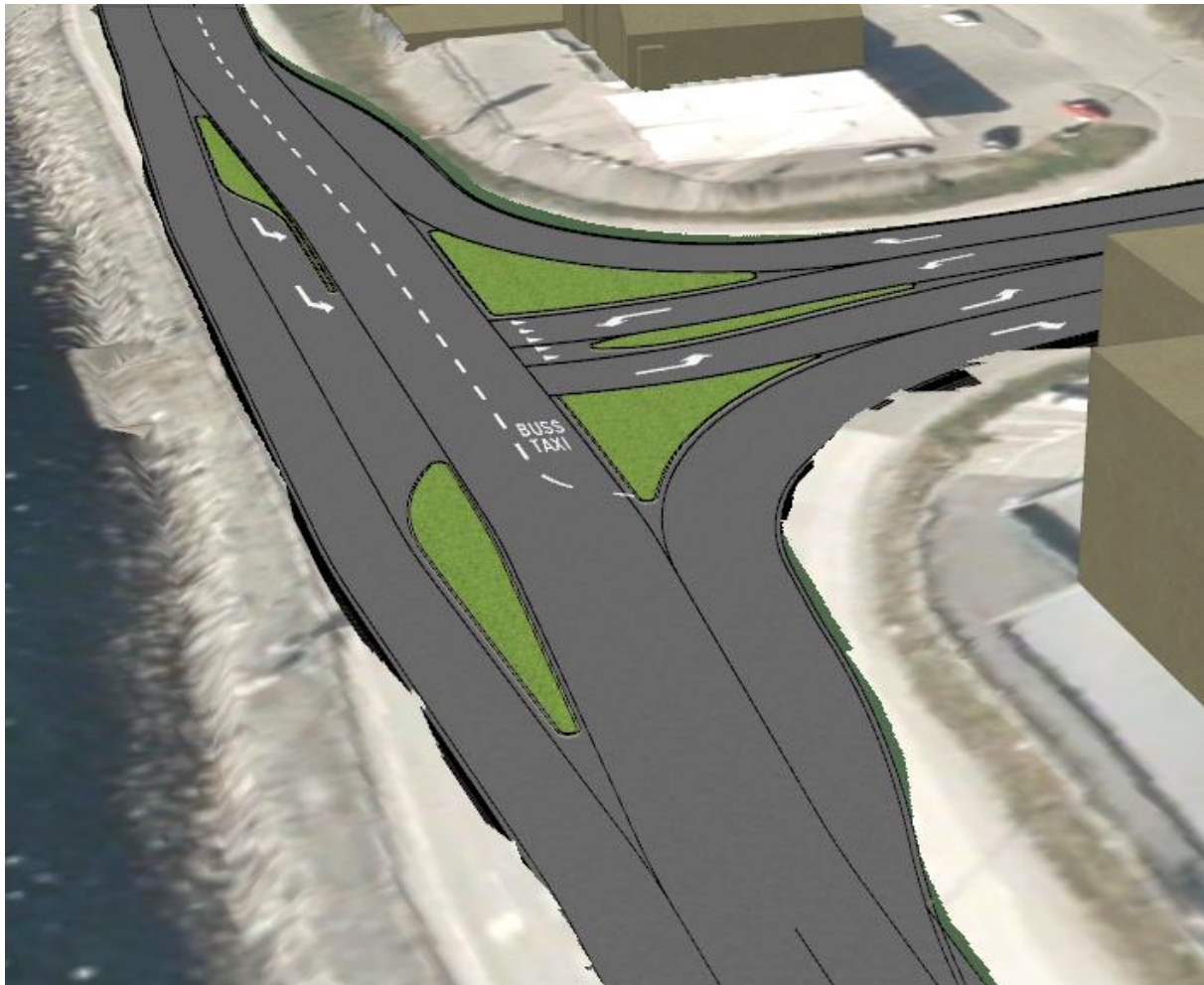
Figur 46. Novapoint modellering av Alternativ 2
