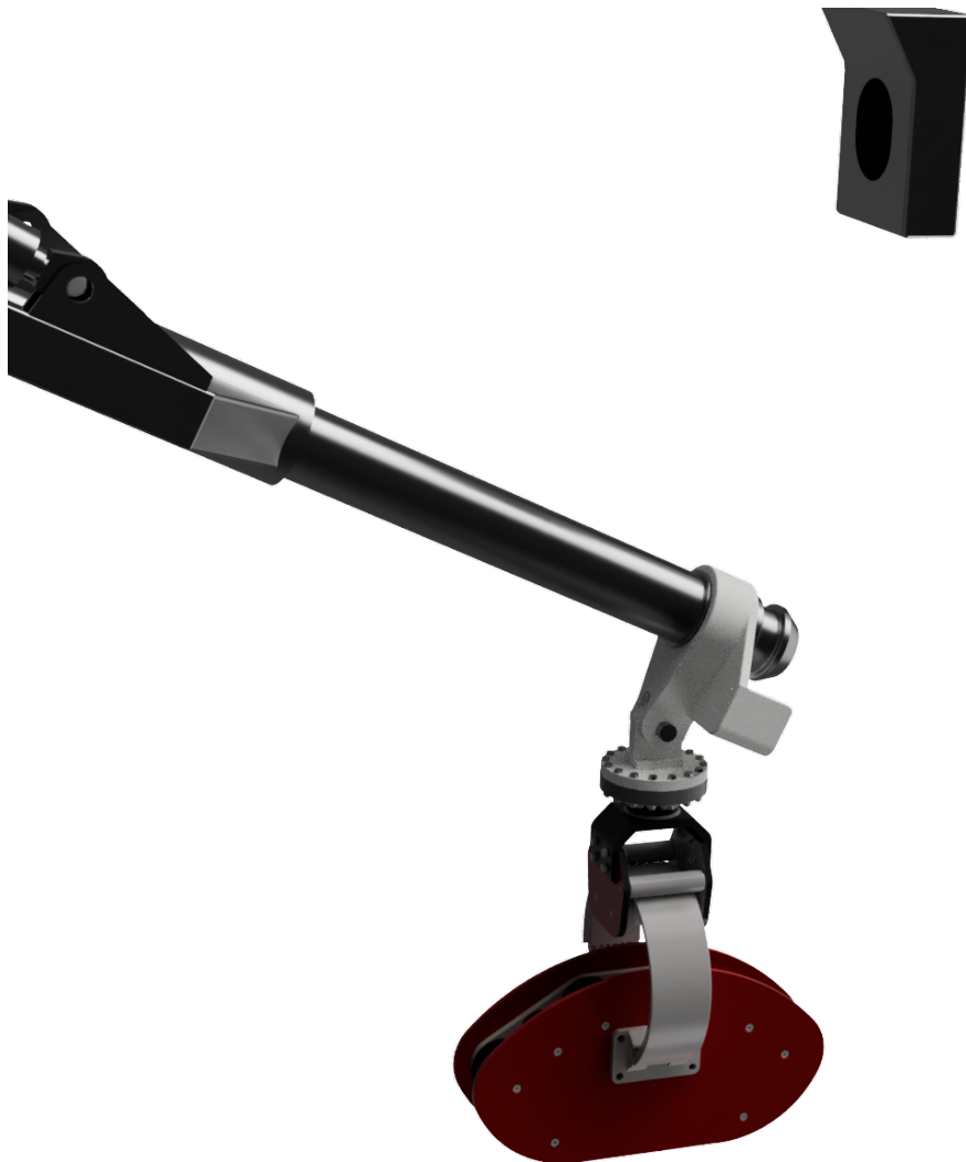
Figur 49: Fastlåst løsning med rotasjonsledd
