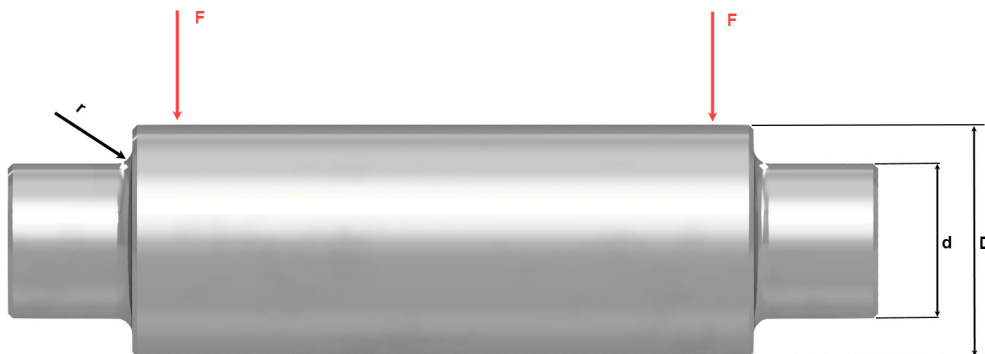
Figur 83: Kjervirkning på hjulaksel.
