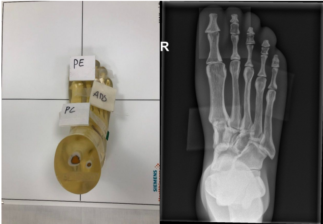
Figur 16 Røntgenbilde av polyetylen, ABS og polykarbonat (foto: Lunderø, 2022)
