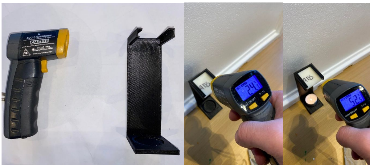
Figur 6 Hvordan stativet og den infrarøde måleren ble brukt til å gjennomføre testen (foto: Fliflet-Jacobsen, 2022)
