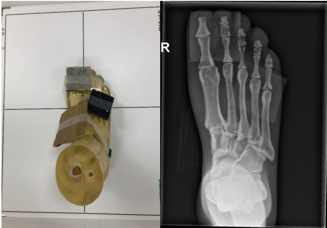
Figur 14 Røntgen bilde av glassfiber, karbonfiber kompositt og papp (foto: Lunderø, 2022)
