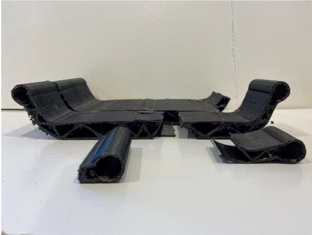
Figur 38 Modell med bølge struktur (foto: Fliflet-Jacobsen, 2022)
