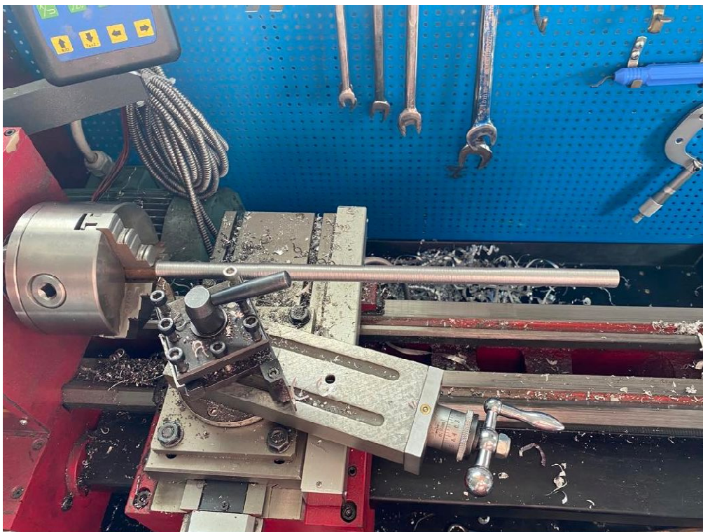
Figur 35 Utvendig diameter justeres fra 15mm til 13mm (foto: Fliflet-Jacobsen, 2022)
