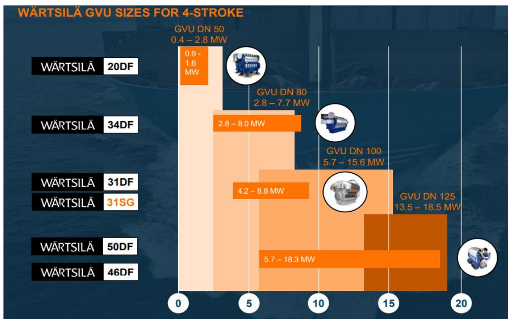
Figur 4, GUV størrelser for 4-takt motorer. Oversikt som viser hvilken motor størrelseorden (4-takter), GUV-ED DN 80 kan drifte (Wartsila, u.d.)
