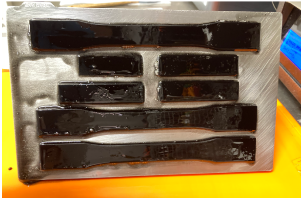
Figur 6: Nyprintet prøvestykkene med CNTs.
