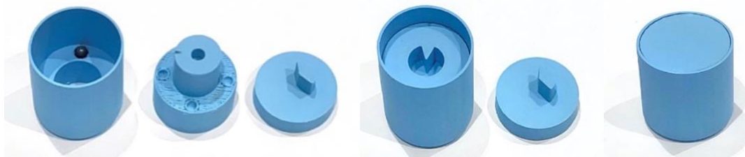
Figur 60 - 3D-printet roteringsmekanisme, steg 1-2-3 for montering av den (Selvillustrert foto, 2022)
