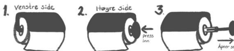
Figur 36 - Separat opphengssystem for toalettrull (Isaksen, 2022)
