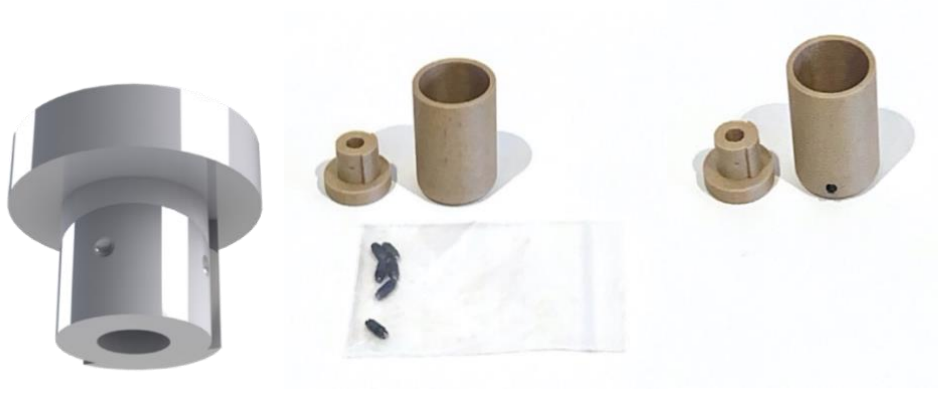
Figur 56 - Rapid prototyping av roteringsmekanisme (Selvillustrert foto, 2022)
