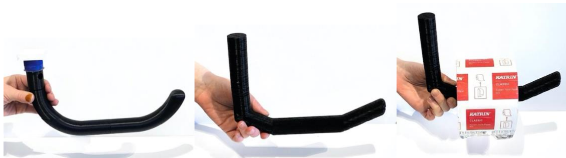
Figur 42 - Rapid prototyping for uttesting av form og vinkling (Selvillustrert foto, 2022)
