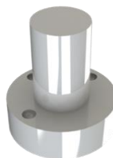
Figur 68 - Rendering av leddet med mekanisk anslag (Isaksen, 2022)
