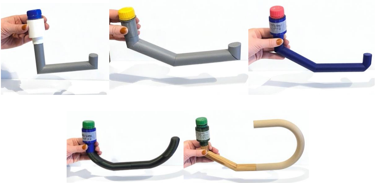
Figur 45 - Funksjonsmodeller av opphengssystem for toalettruller (Selvillustrert foto, 2022)
