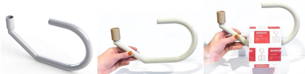
Figur 54 - CAD-modell og rapid prototyping av testversjon 3 (Selvillustrert foto, 2022)
