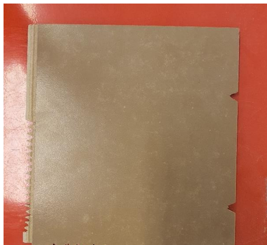
Figur 2 Redskap for testing av rive-evne
