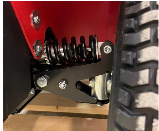
Figur 215 - Egenprodusert bilde av hjuloppheng på Raptor
