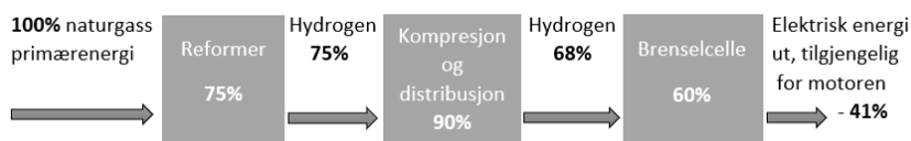
Figur 9 viser energieffektivitet med naturgass som utgangspunkt mellom batteri og brenselcelle [15].
