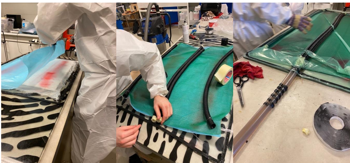
Figur 83 - Bilder fra vakuuminjeksjon i lab. Selvtatte bilder
