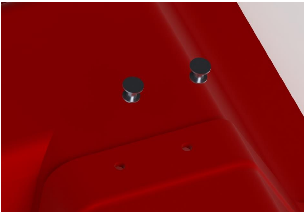
Figur 68 - Render av montering for «pins», konsept 1. Egenprodusert render
