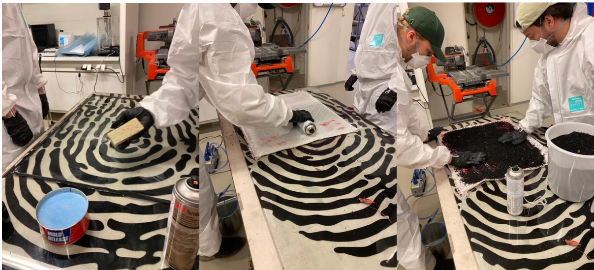
Figur 82 - Bilder fra vakuuminjeksjon i lab. Selvtatte bilder
