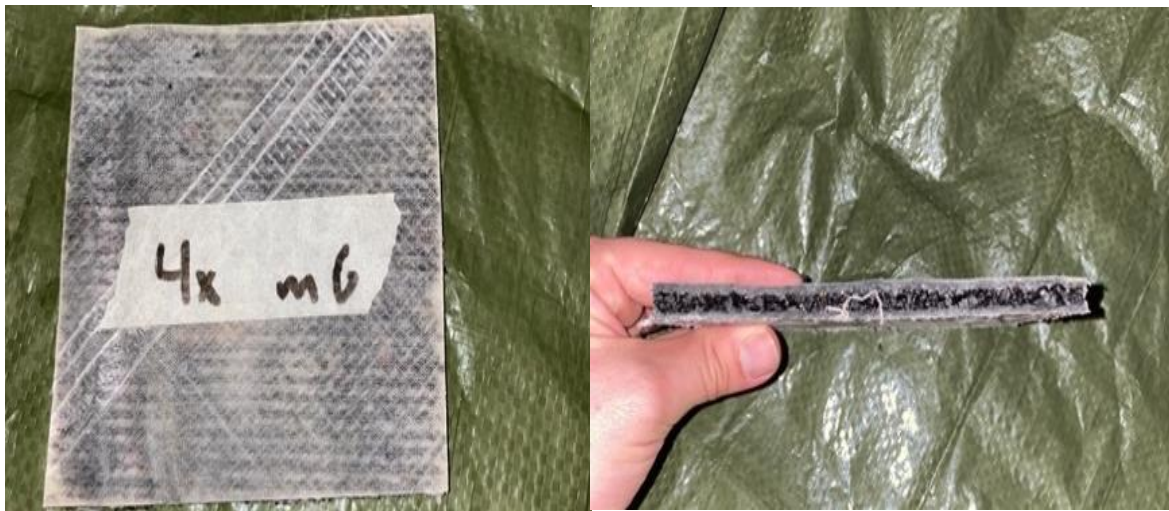
Figur 86 - 2x2 glassfibermatter med granulat. Selvtatte bilder
