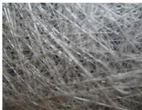
Figur 6 - tilfeldig orienterte diskontinuerlige fibre (CSM). (Modrea, 2014)
