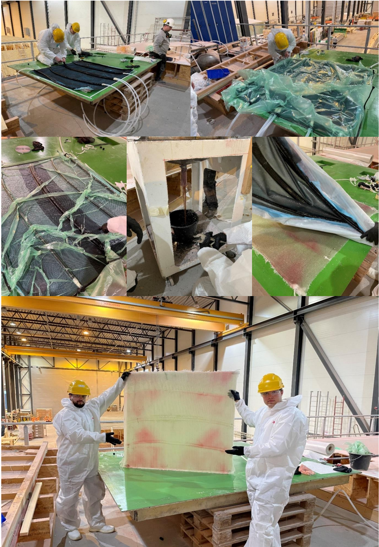
Figur 18 - Sammensetting av bilder fra vakuuminjeksjons prosessen. Selvtatte bilder, med tillatelse fra Jon Inge Brattেকås.
