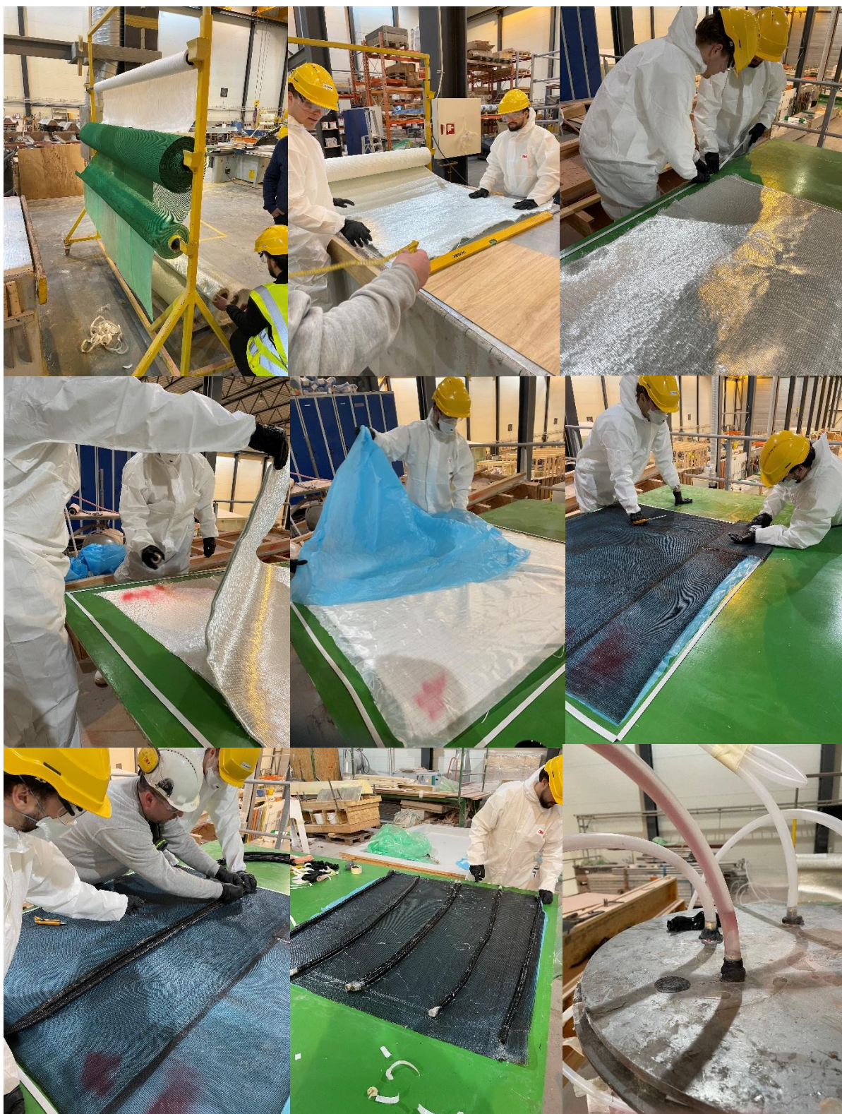
Figur 17 - Sammensetting av bilder fra vakuuminjeksjons prosessen. Selvtatte bilder, med tillatelse fra Jon Inge Brattekås..
