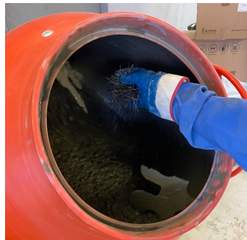
Figur 4 - Basaltfiber tilsettes i frittfalls-blander.
