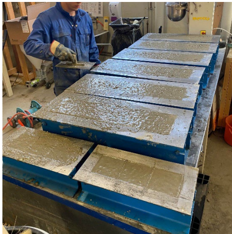
Figur 6 - Formene er fylt og avrettes med et avrettingsbrett.
