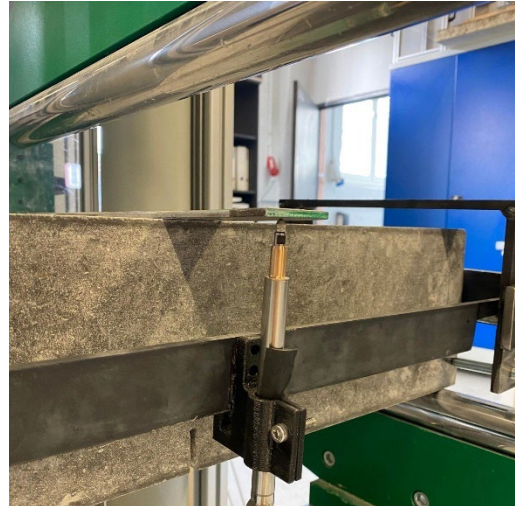
Figur 8 - Bildet av bjelke klar til test. Rigg montert, sensorer justert til kontakt med aluminiumsplate.
