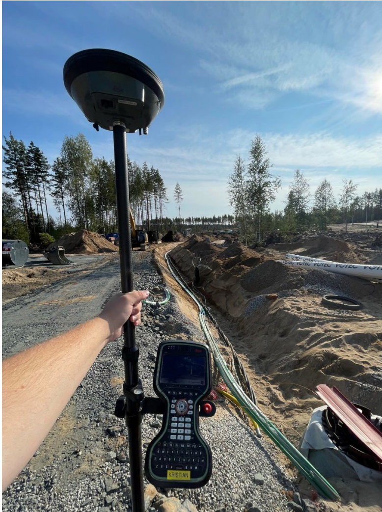
Figur 5 Eksempel på GPS-stav, bilde er fra utstyret til GA
