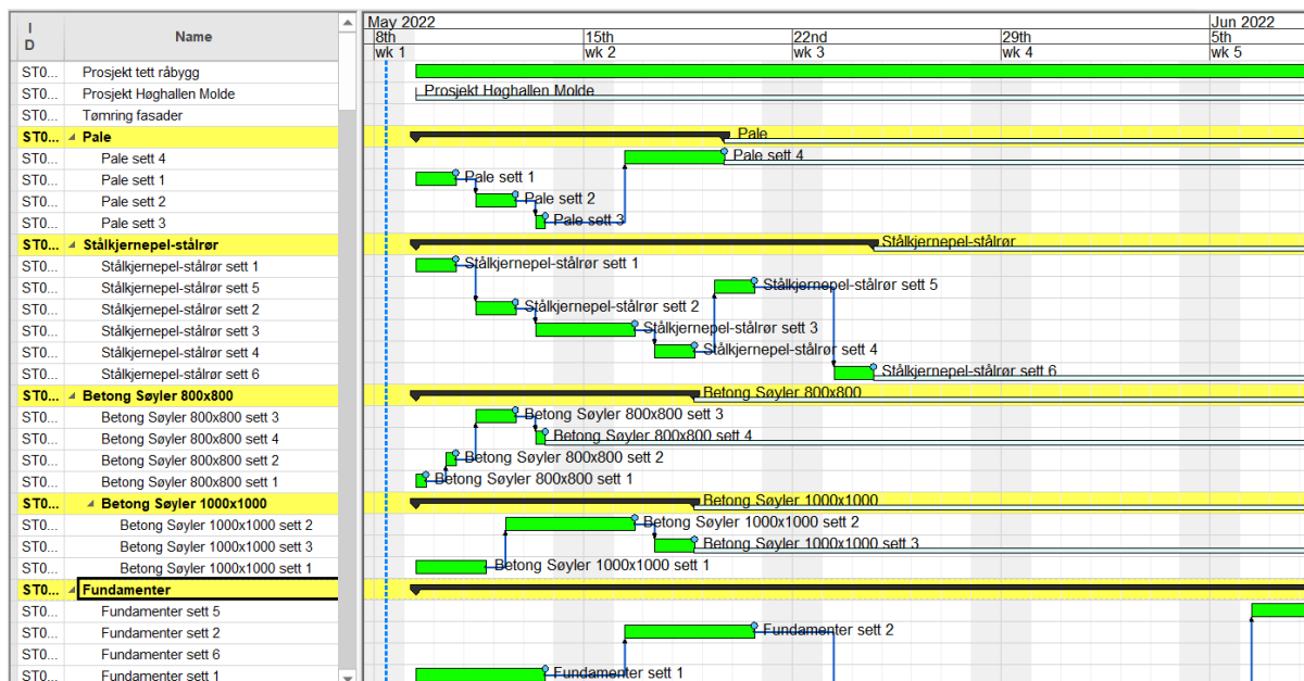
Figur 67 Byggefaser skulle være ferdige samme tid og dag som på fremdriftsplanen i Synchro
