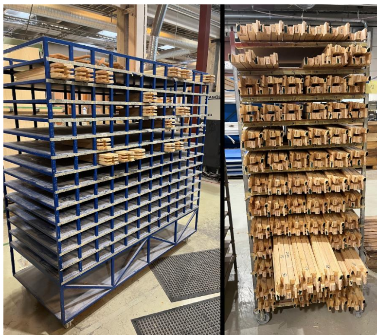
Figur 11: Eksempel på ferdig sorterte rammer i en tralle. Topp og bunn til venstre, og sider til høyre.
