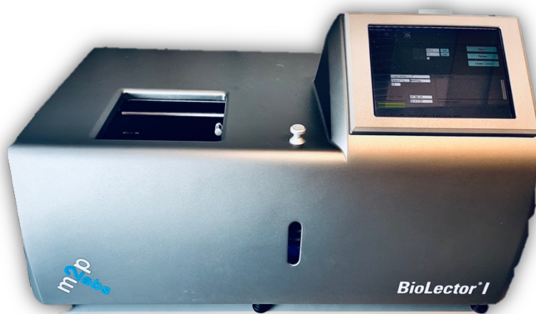
Figur 12 BioLector 1 fra m2p labs brukt under prosjektet. BioLectoren er koblet opp mot en programvare hvor protokoller blir laget og alle målinger blir registrert.
