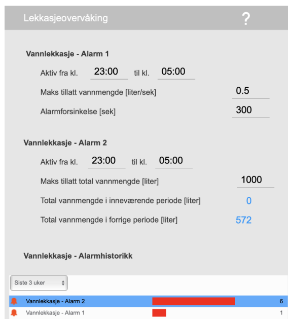
Figur 3.7: Apurgos eksisterende lekkasjeovervåkningssystem
