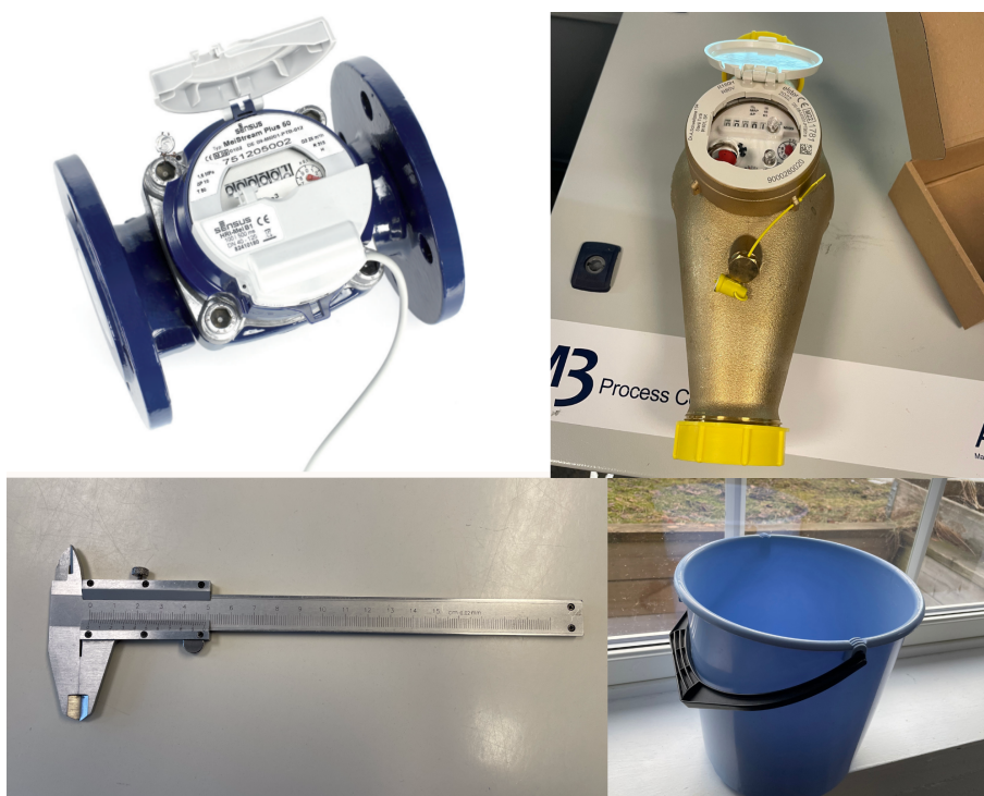
Figur 3.8: Diverse utstyr: to typer vannmålere, skyvelære og bøtte
