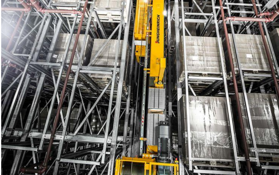
Figur 4: Automatisert pallelager fra Jungheinrich (Bilde hentet fra Jungheinrich.no)
