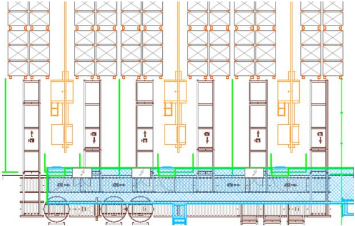
Figur 8: Plukksonen til pallelageret, med loop og buffersoner til kranene.
