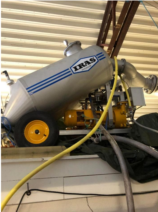
Figur 1. Vakuumpumpe brukt for flytting ved lokalitet B.
