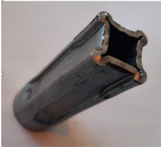
Figur 8: Rør deformert til firkant
