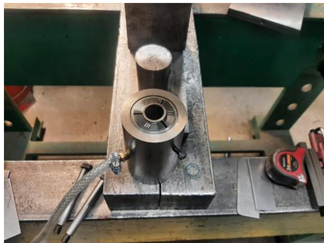
Figur 14: Pressverktøy for testing av pressveising
