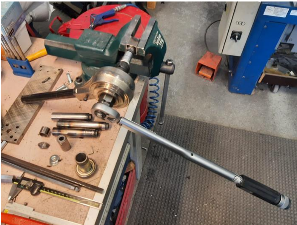
Figur 12: Testrigg, med momentforsterker og momentnøkkel
