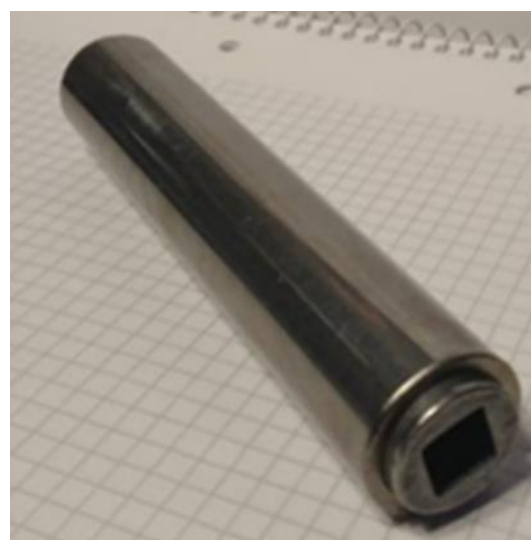
Figur 2: Rør og innsats før sveising
