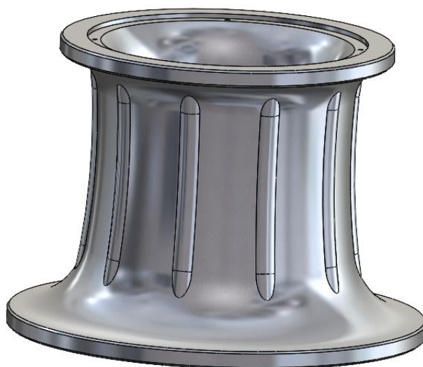
Endelig løsning, 6stk. ribber H = 4mm B = 30mm
