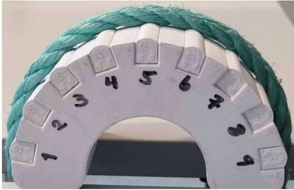
Figur 72 - Konfigurasjon 10 med 2mm ribb
