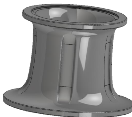
Figur 50 - 3D modell av konsept med riller
