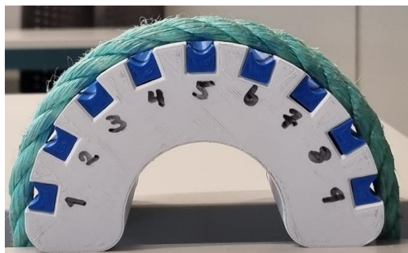
Figur 82 - Deformasjon av tau over rille 4mm
