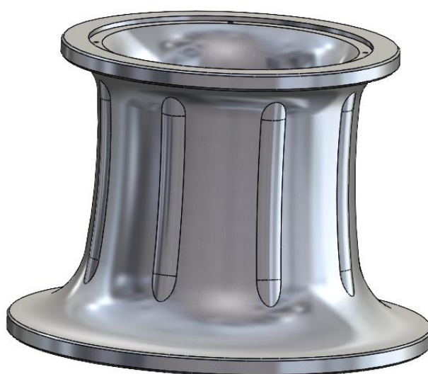
Endelig løsning, 8 stk. ribber H = 4mm B = 25mm
