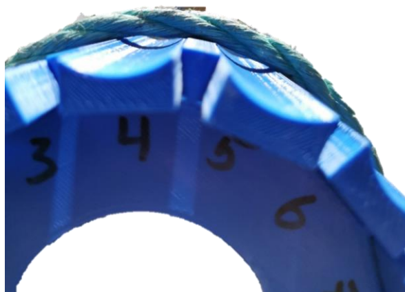
Figur 79 - Taudeformasjon over Rille Halvsirkel
