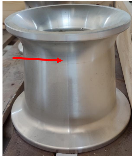
Figur 19 - Oksidert PMH 3tonn kapstanhode
