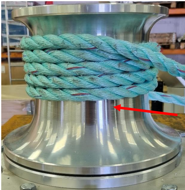
Figur 18 - Nyprodusert PMH 3tonn kapstanhode
