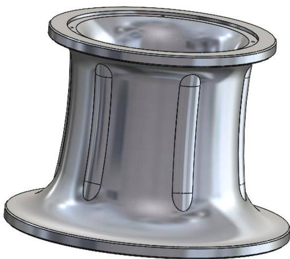
Endelig løsning, 6stk. ribber H = 4mm B = 30mm
