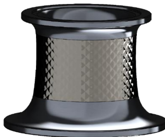
Figur 45 - 3D modell kapstanhode med serratering
