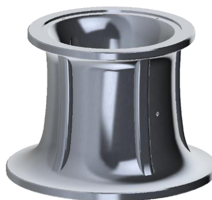
Figur 52 - 3D modell av konsept med ribber
