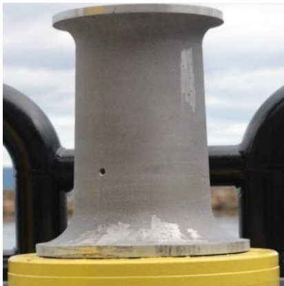
Figur 14 - Støpt kapstanhode (PMH, 2017)
