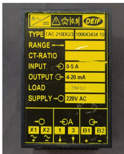
Figur 6-8: Transduser for strømvlesning inn til kontrollrom//kontrollsystem.
