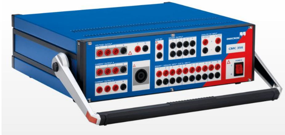
Figur 6-26: Omicron CMC 356 relèverntester. [32]
