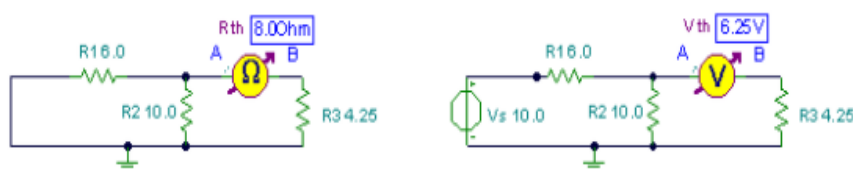
Figur 26 Steg en og to i Thevenin ekvivalent utregning
