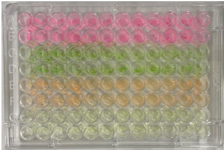
Figur 24: Viser platen som ble benyttet til fluorescensforsøket, med rosa markeringstusj i A- og B-brønnene, grønn markeringstusj i C- og D-brønnene, oransje markeringstusj i E- og F-brønnene, og gul markeringstusj i G- og H-brønnene.
