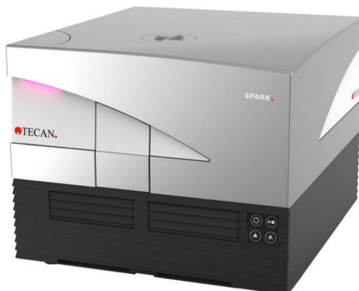
Figur 1: Bilde av plateleseren Tecan SPARK (Tecan Austria GmbH, 2020, s. 1).
