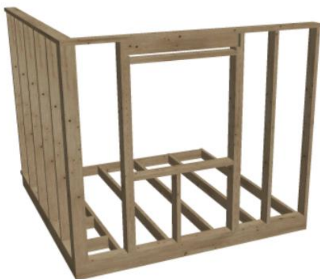
Figur 5: Eksempel på bindingsverk.
