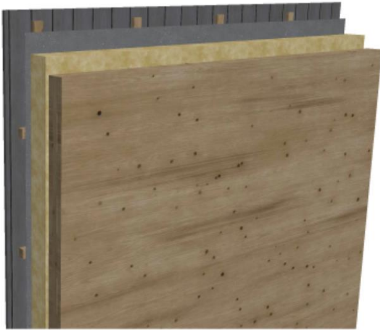
Figur 10: Yttervegg i massivtre.
