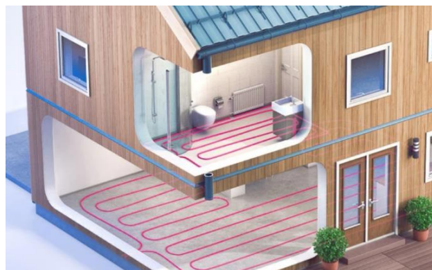
Figur 3 – Vannbåren varme prinsippkisse (Enova, 2022)
