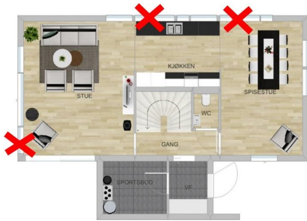
Figur 9 – Dråpen moderne 1. etasje, vindusreduksjon
