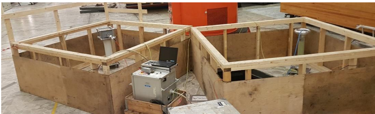
Figur 5: Oppsett for offline PD-måling med 0,1 Hz VLF utstyr.
