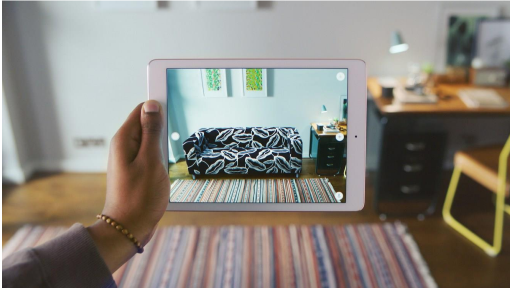
Figur 2. «IKEA PLACE». Viser bruk av appen «IKEA PLACE» hvor man kan få en opplevelse av hvordan et møbel vil arte seg i omgivelsene. Sofaen på tabletskjermen er virtuell. Fra «How Ikea is using augmented reality»(2017) Av Joseph, S
