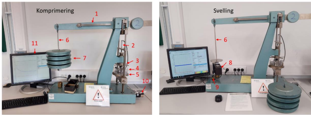
Figur 34: Ødometer satt til komprimering til venstre, og svelling til høyre.
