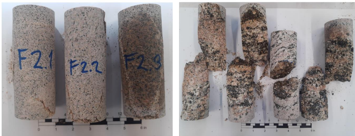
Figur 36: Eit utval av kjerneprøvar etter at dei har gått i brot. Finkorna til venstre, grovkorna til høgre.
