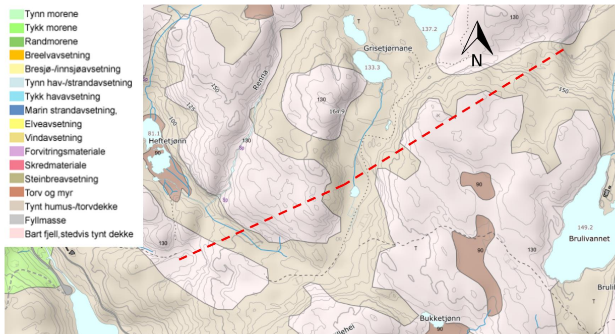
Figur 27: Kvartærgeologisk kart over området (NGU, 2021). Omtrentleg trasé for Bruliheitunnelen er illustrert med raud, stipla linje.
