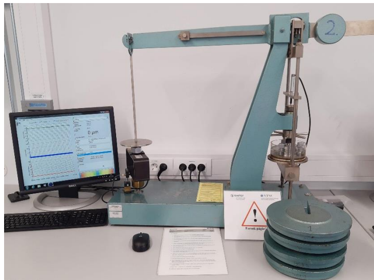
Figur 5: Ødometer som blir nytta til å finne svellepotensialet til leire.
