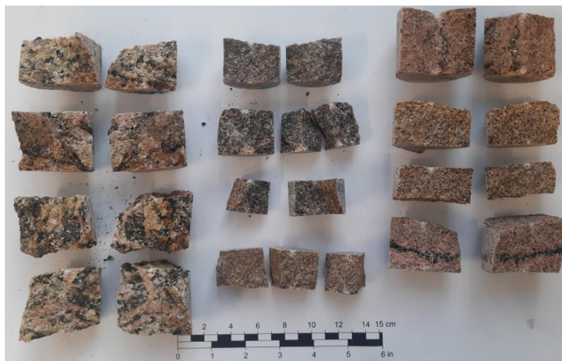
Figur 37: Prøvemateriale etter punktlasttest i aksialretning.
