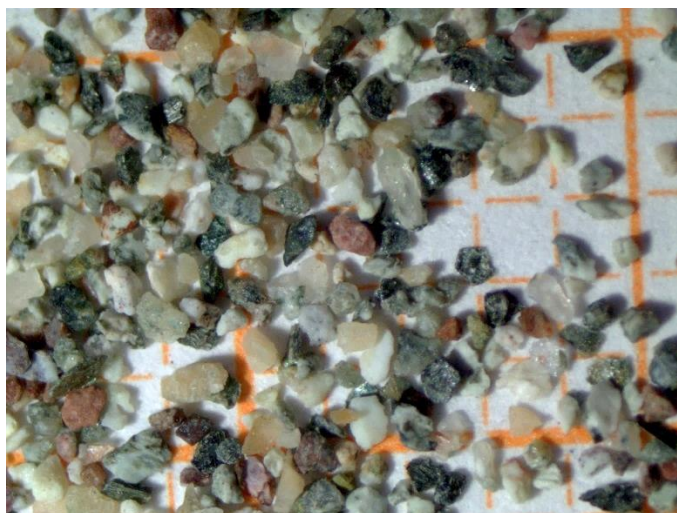
Figur 66: Sleppemateriale med kornstørrelse mellom 500 \mu\text{m} til 250 \mu\text{m} frå Volleberg tunnelen.
