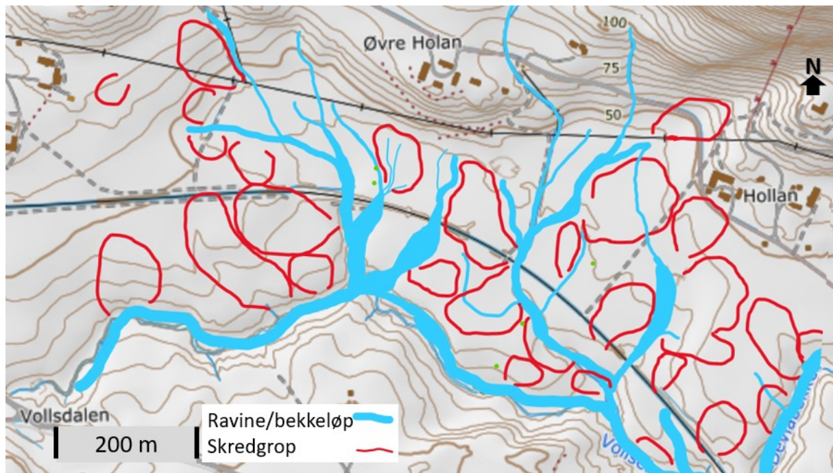
Figur 37. Kart som viser raviner og skredgroper, etter systematisk tolkning av LiDAR- og georadardata.
