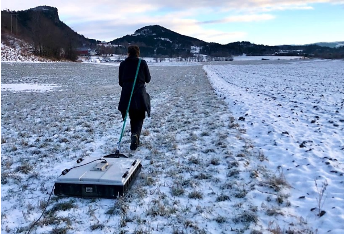
Figur 24. Datainnsamling med georadar på snødekt åker i studieområdet. Foto: Erling Siggerud.
