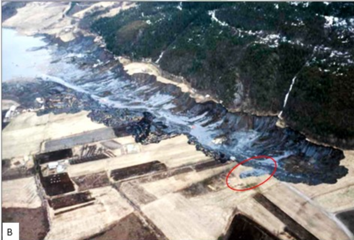
Figur 22. A) Ekstensionsstrukturer (horst-grabener) etter skred i Quebec. Foto av Leroueil, fra Hungr, et al. (2013). B) Skredgrop med lite skredmateriale etter Rissaskredet i 1978. Flytende kvikleire har også blitt presset opp vertikalt, under nedsenkning av tørrskorpen (rød ring). Foto av Erik Thorberg.
