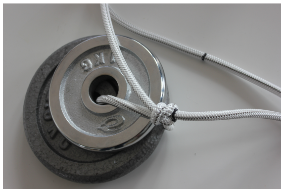
Figur 98: Oppsett for test av forlengelse.
