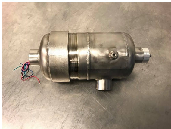
Figur 95: Resultat planetmodul med påskrudd muffe.
