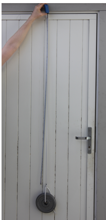
Figur 99: Test av forlengelse av gummline.
