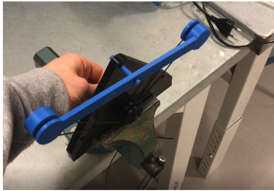
Figur 37: Prototype av to-delt vinsj
