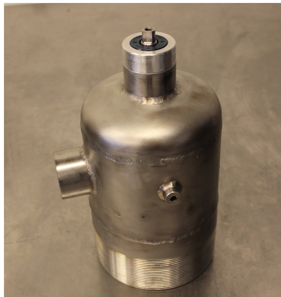
Figur 94: Resultat planetmodul uten påskrudd muffe.
