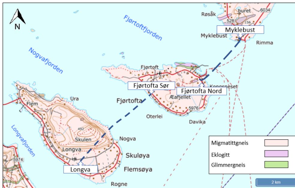
Figur 29: Kartutsnitt hentet fra berggrunnsdatabasen til NGU. Påhuggsområdene for Nogvafjordtunnelen og Fjørtoftfjordtunnelen er navngitt.
