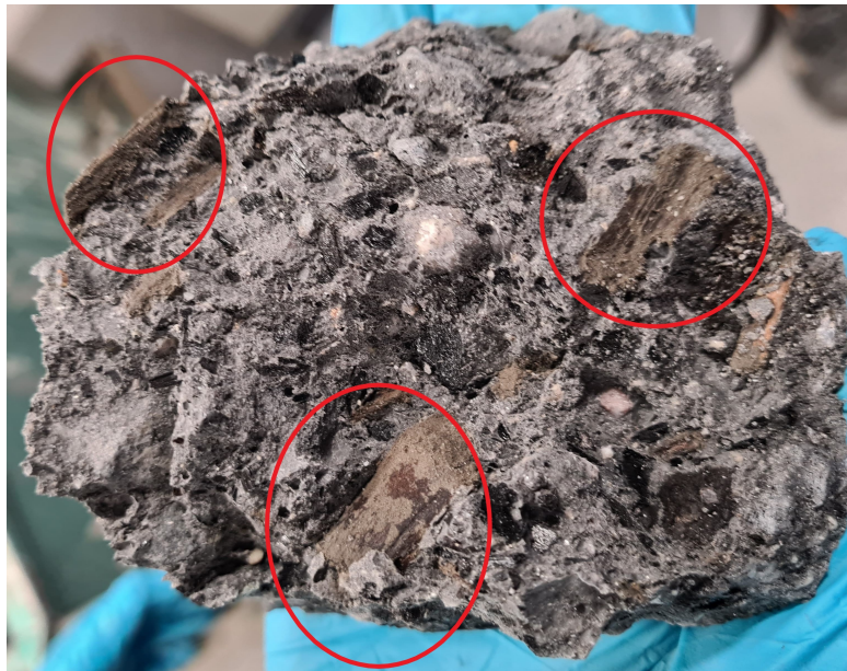
Bilde 8.1.1: Bruddflaten til en av terningene testet på laboratoriet. Det er markert tre store biter med biokull/trevirke.
