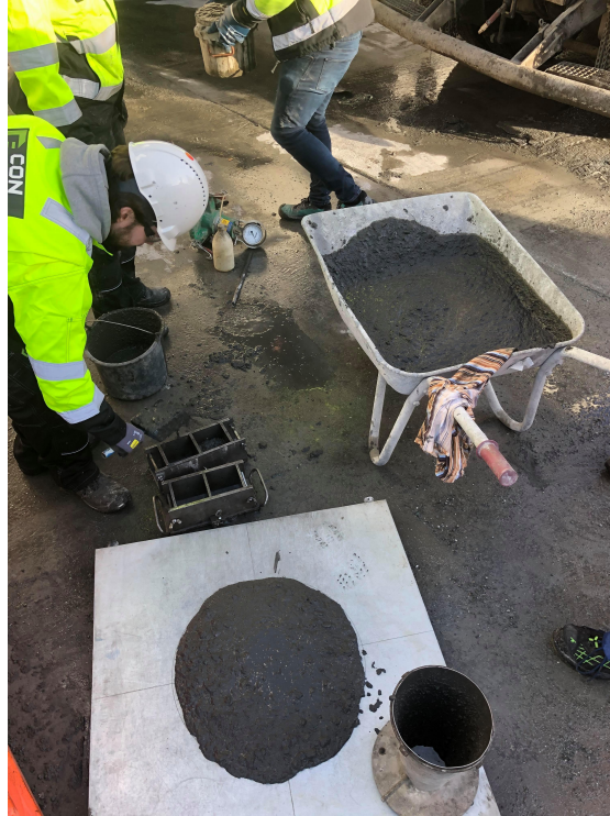
Bilde 11.4.1: Bilde fra testing av den ferske betongen. Fremst i bildet ser man en slumpetest og utbredelsestest, mens lengre bak ser man terninger som fylles.
