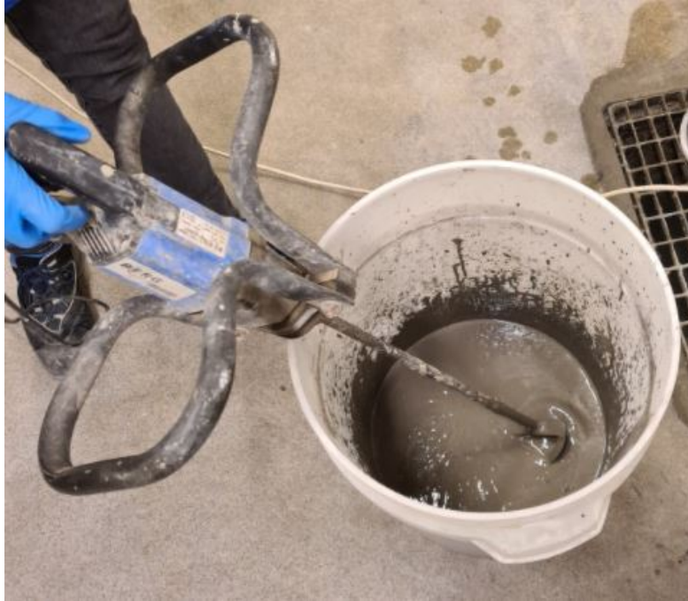
Bilde 6.1.2: Blanding av sementlim med sementmikser.
