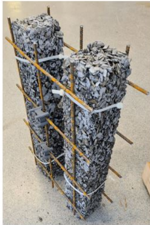
(c) Biokullstavene festet med strips til armeringen.
