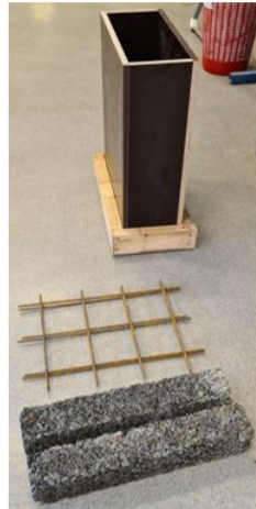
(d) Oppsettet av veggelementet med biokullstaver
