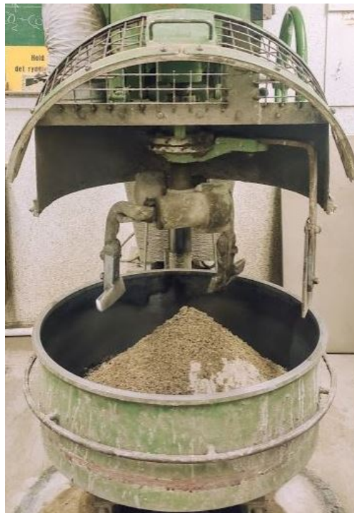
Bilde 6.1.1: Bilde av blandemaskinen benyttet på laboratoriet. Bildet er tatt like etter alt tilslaget, sementen, silika og biokull for en vangebetong er lagt i maskinen. Her ser man at deler av sanden ligger helt på toppen for å pakke inn de andre delmaterialene slik at det ikke skal støve så mye når blandingen starter.
