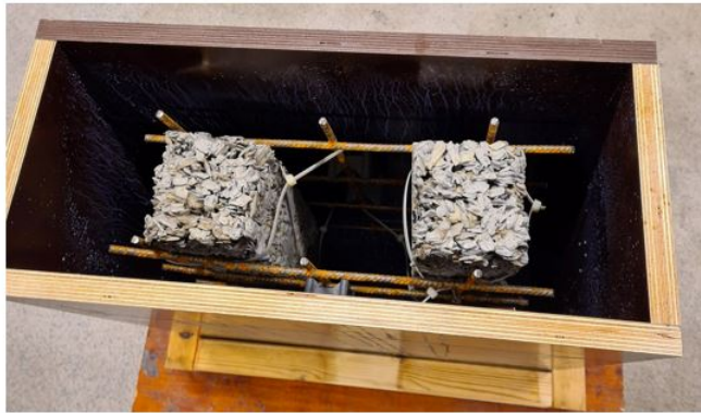
(b) Biokullstavene i formen for utstøping.
