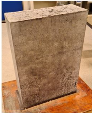
(a) Veggelement med biokullstaver ferdig herdet.
