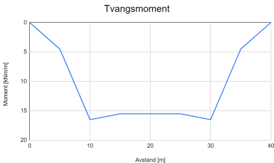
Figur 21: Tvangsmomentet for L_x = 10 m med armeringsmengde A_p = 1500 \text{ mm}^2 per meter.
