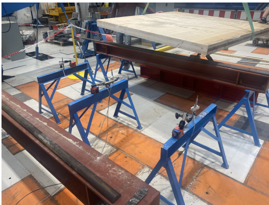
(a) Plassering av LVDT-sensorene.
