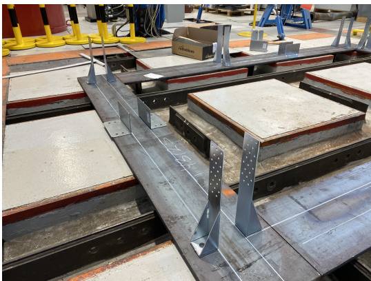
(a) Stålramme med korrekt plasserte forbindelser.
