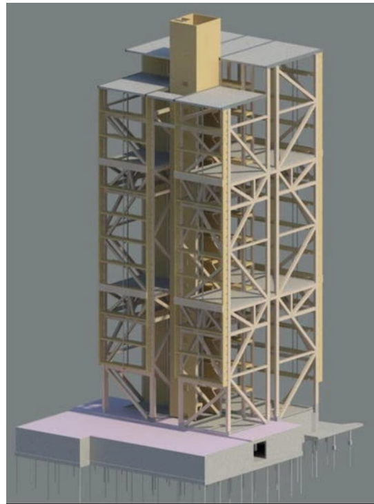
(b) 3D-modell av strukturen, her kan betongelementene ses .
