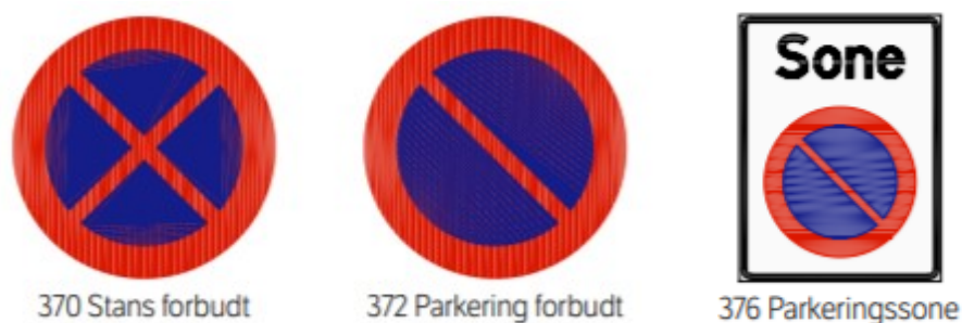
Figur 47: Skilt som regulerer stans og parkering i Torggata. Skiltet Stans forbudt 370 gjelder i Torggatas tilfelle for vareleveringslommene i morgenrushen, mellom 07.00 og 09.00 på hverdager. For øvrig tid gjelder parkering forbudt. Skiltene er hentet fra Trafikkskilt - Vegoppmerking og trafikksignaler (Statens vegvesen, 2018)
