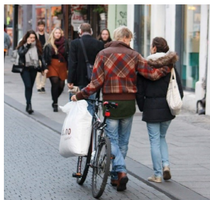
Figur 53: Lav nivåforskjell (4 cm) mellom kjørebane og fortau er en mulig forklaring på det høye konfliktnivået i Torggata. Hekne (2017) anbefalte å øke denne til 6 cm. Foto: Anders Hartmann
