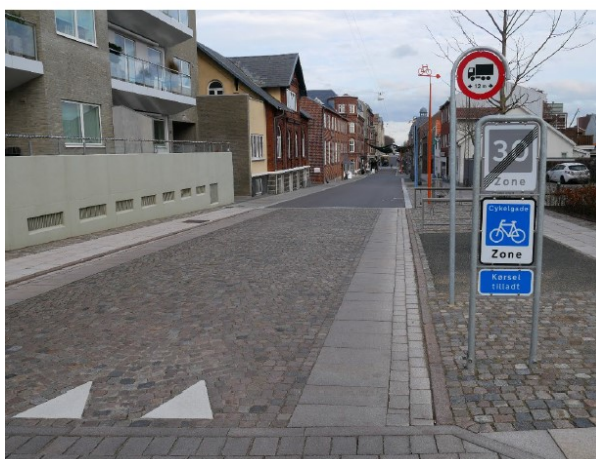
Figur 16: Et eksempel på hvordan en skilte en sykkelgate i Danmark der motorvogn opp til 12 meter er tillatt. I dette tilfelle opphører fartsgrensesonen 30km/t og blir erstattet med sykkelgatesone hvor motoriserte kjøretøy skal tilpasse hastigheten til syklister og lett-mopedister. Foto: Vejregelgruppen Byernes trafikarealer (2019)
