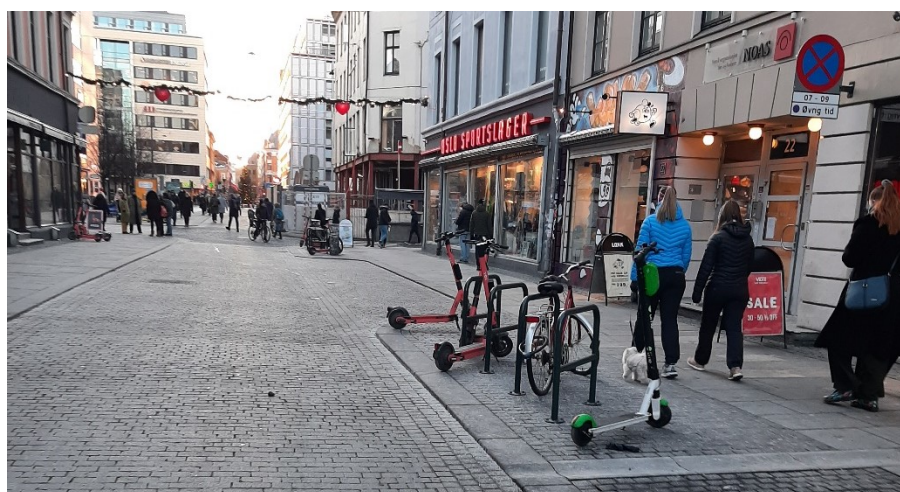
Figur 45: Sonen til høyre i bildet brukes vekselvis til varelevering og møblering. Møbleringssonen benyttes her til sykkelparkering. I underlaget er smågatesteinen lagt i et annet mønster som danner et skille mellom kjørebane og vareleveringslomme. Foto: Henning Stokstad
