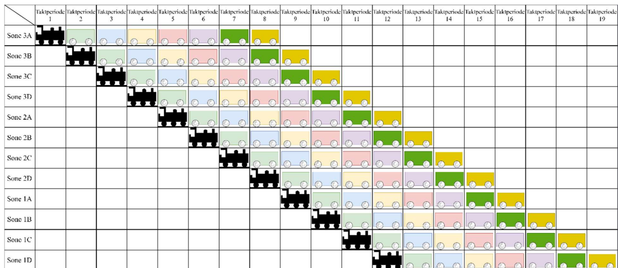
Figur 8 – Taktplan som viser hvilken arbeidssone hver vogn jobber i til hvilken tid
