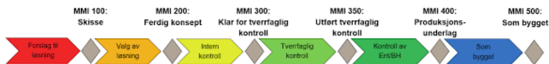
Figur 3.3: Prosjekteringsaktiviteter som leder til ulike MMI-verdier. Figuren er hentet fra EBAs nettsider.
