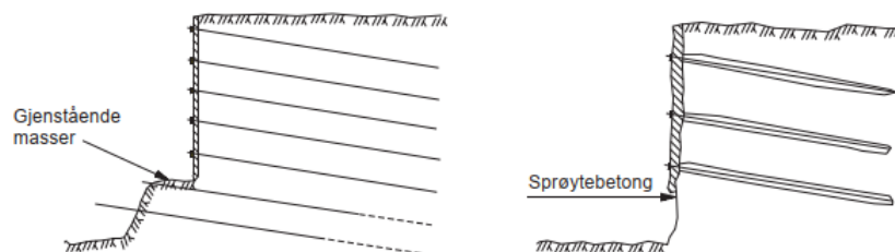
Figur 2.7: Tiltak for å øke lokal stabilitet ved lav kohesjon i utgravningsfasen (Statens Vegvesen, 2002).
