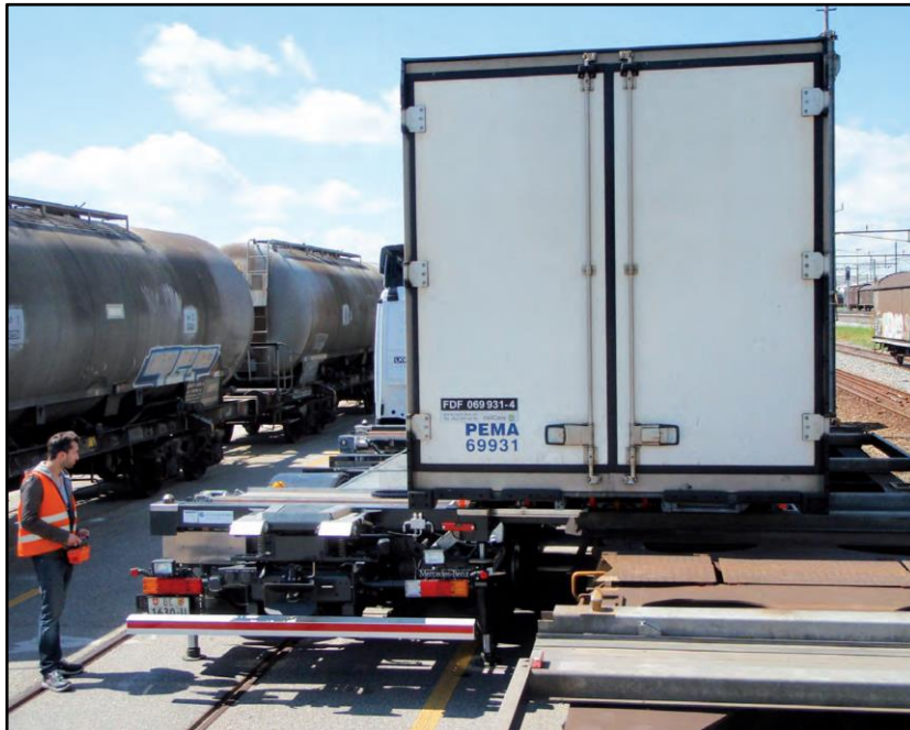
Figur 10: Omlasting mellom bil og bane ved hjelp av systemet ContainerMover fra Innovatrain. Figur hentet fra InnovaTrain (u.å).
