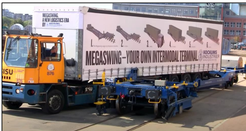
Figur 9: Semitrailer som rygger inn på en Megaswing-togvogn. Figur hentet fra Kockums Industrier (2010).
